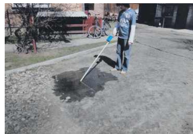
Bardzo ciekawym i praktycznym wynalazkiem jest laska wspomagająca poruszanie się osób niewidomych i niedowidzących. Urządzenie ostrzega przed kałużą rozróżniając jej głębokość. Na płytce kałuży układ nie reaguje, przy głębszej słychać komunikat: „Uwaga woda”
