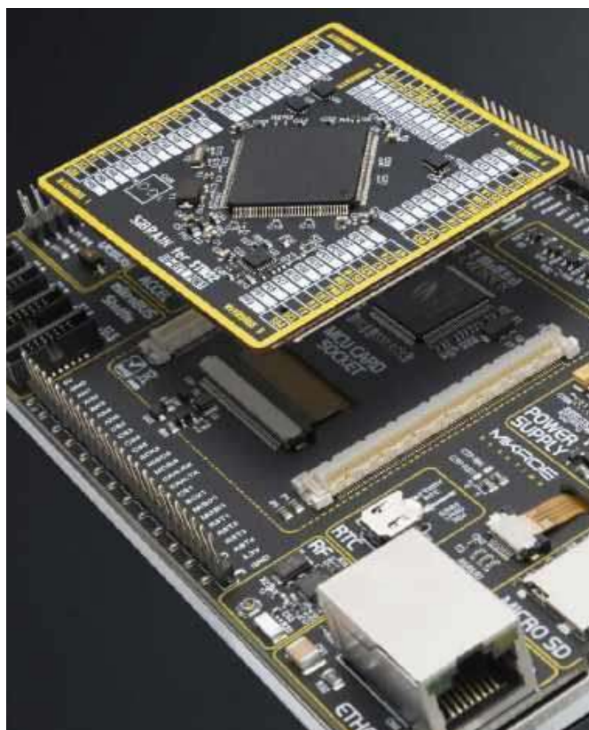
Fotografia 4. Przykładowa płytka wg standardu SiBRAIN wraz z kompatybilną płytą bazową ( http://t.ly/H7DEC )
