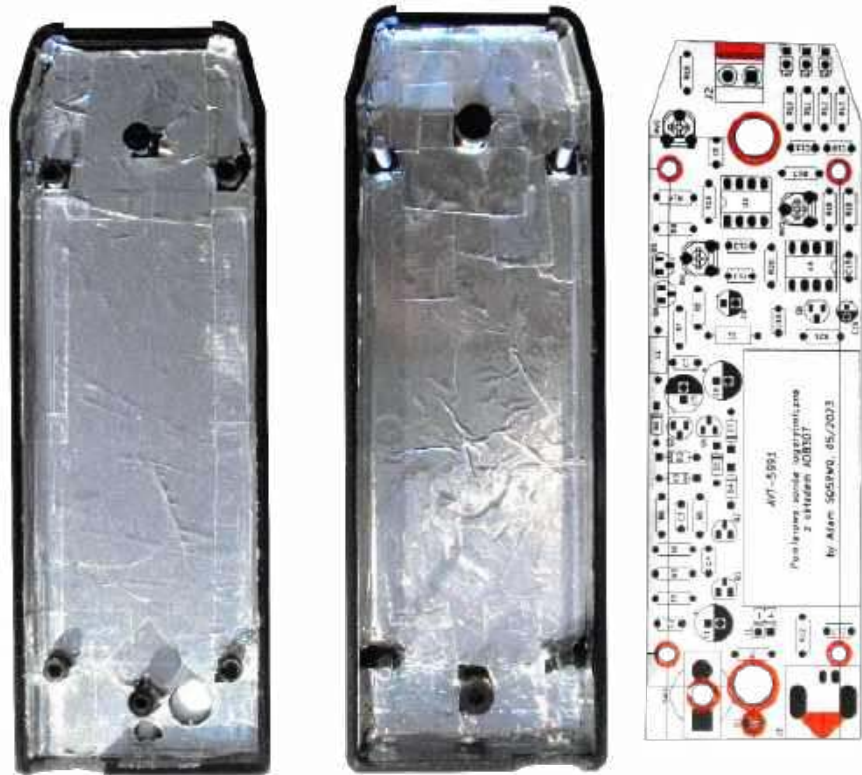
Fotografia 2. Obudowa sondy przygotowana do montażu
