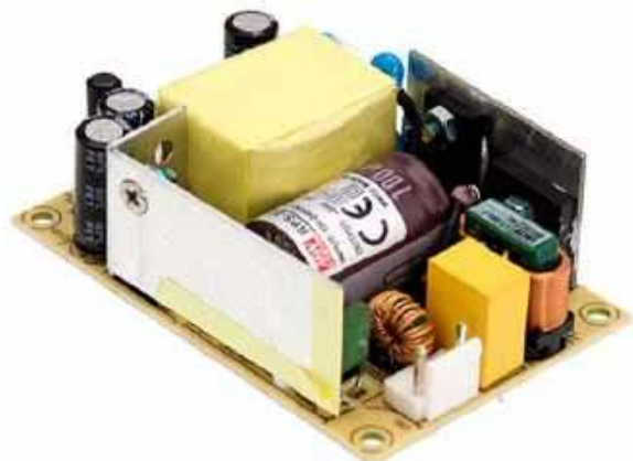
Fotografia 7. Zasilacz małej mocy (45 W) chłodzony pasywnie ( http://t.ly/6rm4y )
