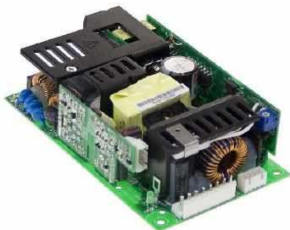
Fotografia 8. Zasilacz o mocy 160 W wymagający konwekcji wymuszonej do osiągnięcia pełnej mocy wyjściowej ( http://t.ly/y3t2U )
