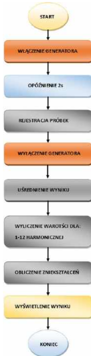
Rysunek 3. Wykaz czynności wykonywanych w procedurze pomiaru
