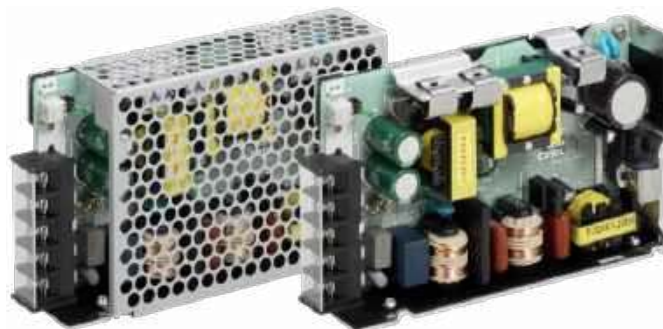
Fotografia 1. Budowa zasilacza SMPS o mocy 75 W bazującego na schemacie blokowym z rysunku 1 ( http://t.ly/sUHNr )
