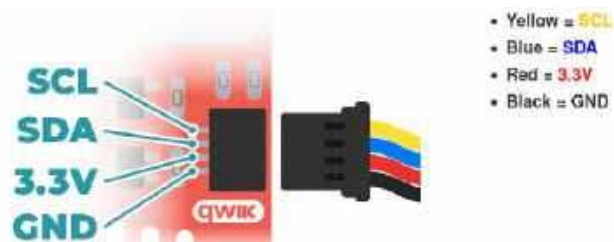
Rysunek 8. Układ wyprowadzeń złącza Qwiic ( http://t.ly/9m6mT )
