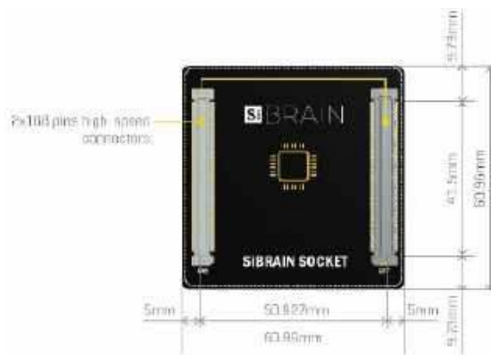
Rysunek 5. Wymiary płytek wg standardu SiBRAIN ( http://t.ly/5oCnh )
