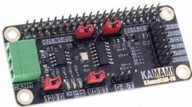
Fotografia 13. Nakładka KamodRPi CAN-FD w formacie Raspberry Pi Zero ( http://t.ly/VLV3M )
