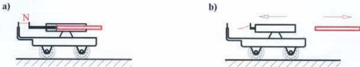
Rys. 4. Eksperyment ilustrujący prawo zachowania pędu. a) wózek przed wyrzutem, b) wózek po wyrzucie. Źródło: Źródło: J. Liwo, B. Porala, Materiały pomocnicze z fizyki. Materiały wewnętrzne WFTiMS PG
