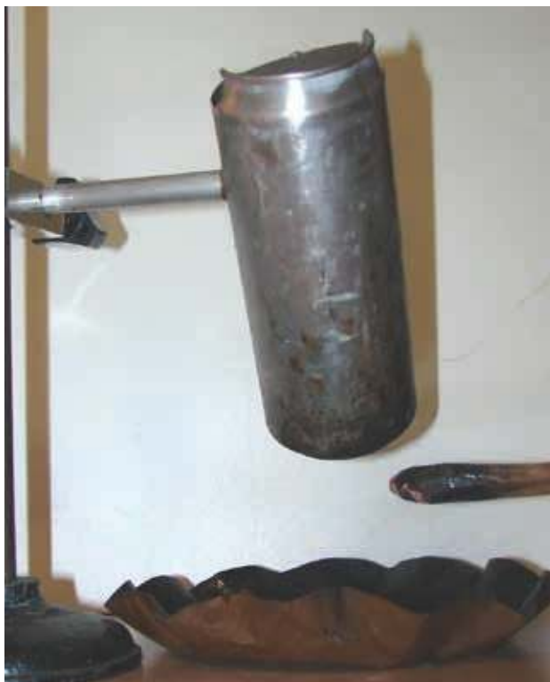
Rys. 5. Różnicę temperatury skraplania gazowego tlenu i azotu pokazujemy w efektywnym doświadczeniu. Na zewnętrznych ściankach aluminiowego naczynia wypełnionego ciekłym azotem skrapla się tlen i zaczyna spadać w postaci kropeł. Tłące się luczywko umieszczone poniżej zapala się płomieniem, ilekroć spadnie na nie kropla tlenu. Stąd ta piękna polska nazwa: „tlen” (w innych językach albo oxygen jak po grecku, albo kisko-rod po rosyjsku). Po latach doświadczeń, puszką, na której skrapla się „ulteniający” tlen, jest jakby spalona.
