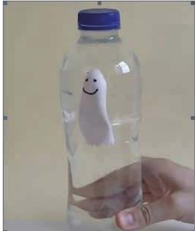
Foto. 2. „Duszek” zanurzający się i wypływający w zależności od ciśnienia wywieranego na butelkę. Ekspresje pokazu zwiększa zastosowana przez autorów muzyka. Fragment Tokaty Jana Sebastiana Bacha. https://www.youtube.com/watch?v=Y5JwNPtAqOM
