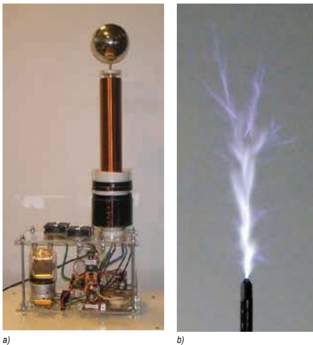
Foto. 3. Transformator Tesli zbudowany na Wydziale Fizyki Technicznej i Matematyki Stosowanej Politechniki Gdańskiej przez inż. Jarosława Nowakowskiego. Wyładowanie koronowe emitowane z ostrza uzwojenia wtórnego transformatora.
