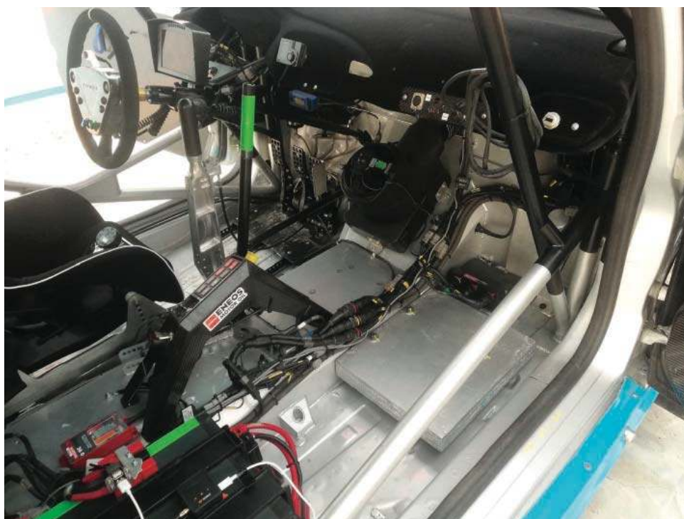
Z prawej strony podłogi zamontowano ołowianą płytę
