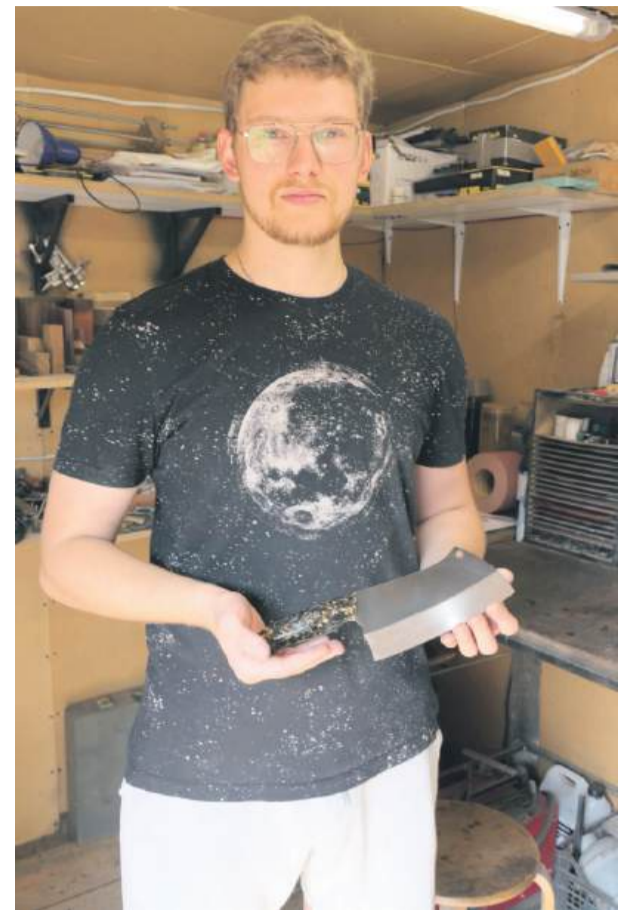
Mieszko Górski prezentuje własnoręcznie wykonany tasak kuchenny do porcjowania mięsa z nierdzewnej stali. Na rękojeści materiał hybrydowy - płatki mosiądzu z włóknem węglowym w żywicy epoksydowej
