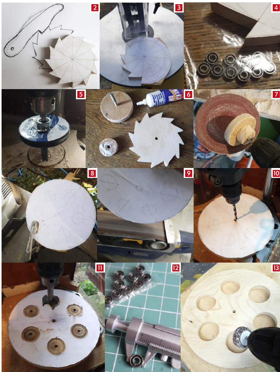
2. Koło zapadkowe i zapadka; 3. Wycinanie zębów koła za pomocą piły włosowej; 4. Malutkie łożyska zapewnią znikome tarcie; 5. Wycinanie krążka ze sklejki; 6. Montaż mechanizmu obciążnika; 7. Tak obrabiamy koła ze sklejki; 8. Koło zamachowe wycinamy wyrzynarką; 9. Zgrubnie obrabiamy koło szlifierką taśmową; 10. Po napunktowaniu wiercimy otwór na oś; 11. Wiercenie otworów 40 milimetrów w kole zamachowym; 12. Łożyska o średnicy 7 milimetrów; 13. Koło zamachowe;
