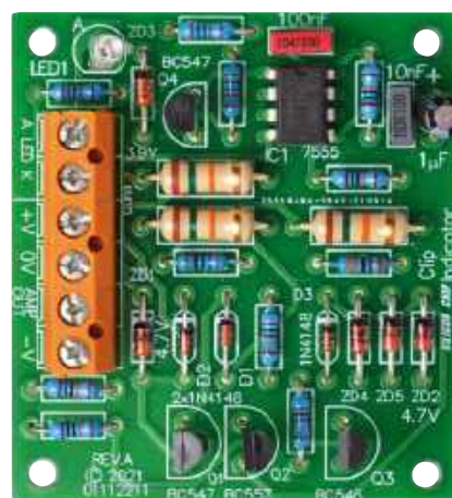
Rysunek 2. i 3. Płytką nie jest trudna w montażu. Elementy należy zamontować tak, jak pokazano po lewej stronie. Diody, LED, układy scalone i kondensatory elektrolityczne są spolaryzowane. Jeśli budowana jest wersja monofoniczna lub stereofoniczna do sterowania dwoma niezależnymi diodami LED, należy zbudować płytkę ze wszystkimi elementami. W przypadku wersji stereofonicznej z pojedynczą diodą LED wskaźnika przesterowania, powinna być wykonana jedna z każdej wersji, a następnie wskazany pad powinien być potoczony z dwiema płytkami (nie ma go na prototypowej płytce drukowanej na zdjęciu)
