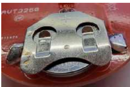
Fotografia 3. Bateria CR2032 zamontowana w słocie tworzącym przez powierzchnię płytki PCB z przylutowaną do niej, dołączoną do zestawu, profilowaną blaszką
