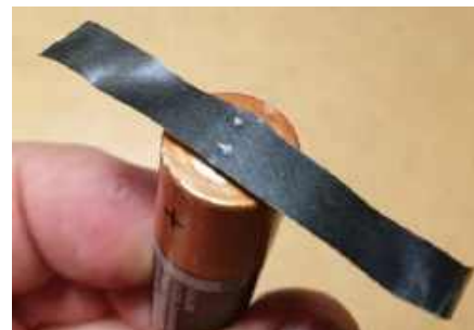
Przykład zgrzewania blaszki niklowej o grubości 0,12 mm przy napięciu 15 V i czasie zgrzewania 20 ms na ogniwie AA używanym do testów. Zgrzanej blaszki nie można oderwać przy użyciu rozsądnej siły
