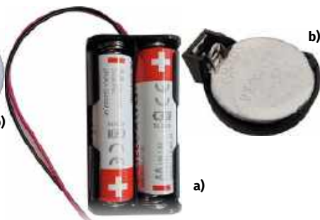
Fotografia 6. Poprawny montaż baterii a) w koszyczku na dwie baterie AA (R6) b) w uchwycie na baterię CR2032
