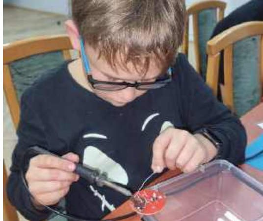
Fotografia 10. Karol podczas montażu blaszki baterii do bombki LED. Koło Młodych Entuzjastów Elektroniki, Szkoła Podstawowa nr 86, Wrocław
