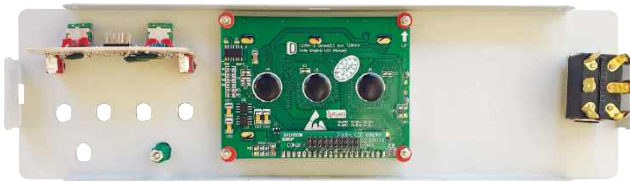
Akrylowa ramka powinna być przymocowana do obudowy za pomocą śrub M3, następnie wsuwamy na nie wyświetlacz LCD i dokręcamy go do akrylu za pomocą izolatorów pod nakrętkami
