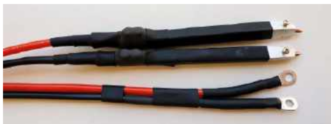
Kable zgrzewarki i sondy z miedzianymi końcówkami
