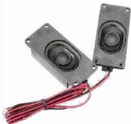
Głośnik 3 W zastosowany w prototypie. Działa bardzo dobrze i można taki polecić, ale istnieje też wiele innych opcji
