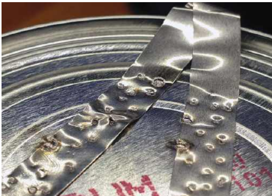
Po zbudowaniu zgrzewarki CD Welder warto wykonać kilka spoin testowych na elementach złotowanych. Pozwoli to zorientować się, jakie napięcie i ile czasu potrzeba do utworzenia przyzwoitej spoiny. Zbyt duża energia spali i zniekształci metal, a nawet zrobi w nim dziury, jak pokazano na lewej blaszce. Po prawej stronie widać, że udało nam się przyspawać blaszkę do puszkę bez jej zniszczenia
