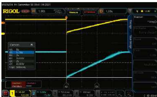
Oscylogram 2. Krzywa napięcia ładowania ze wszystkimi dziesięcioma ESM równolegle. Tym razem prąd ładowania wynosi 5 A, a korzystając ze wzoru podanego w tekście, obliczamy całkowitą pojemność jako minimalnie poniżej 1,2 F
