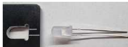
Fotografia 15. Zintegrowana w płytce giętarki do zaginania wyprowadzeń diod LED na określonej i powtarzalną długość. Białe linie wskazują gdzie umieścić dłuższe a gdzie krótsze wyprowadzenie diody LED
