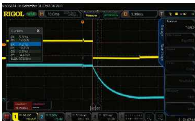
Oscylogram 3. Impuls 200 A do obciążenia. Żółty przebieg to napięcie na wyjściu ujemnym. Niebieski przebieg to napięcie kondensatora, które wykazuje spadek dla początkowego impulsu, a następnie spadek wykładniczy!
