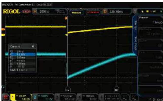
Oscylogram 1. Krzywa napięcia ładowania dla pojedynczego modułu magazynowania energii przy 2 A. Napięcie wzrasta o 10,5 V w ciągu 616 ms. Zwróć również uwagę na widoczną tutaj krzywą rozładowania, którą obliczamy jako 130 A
