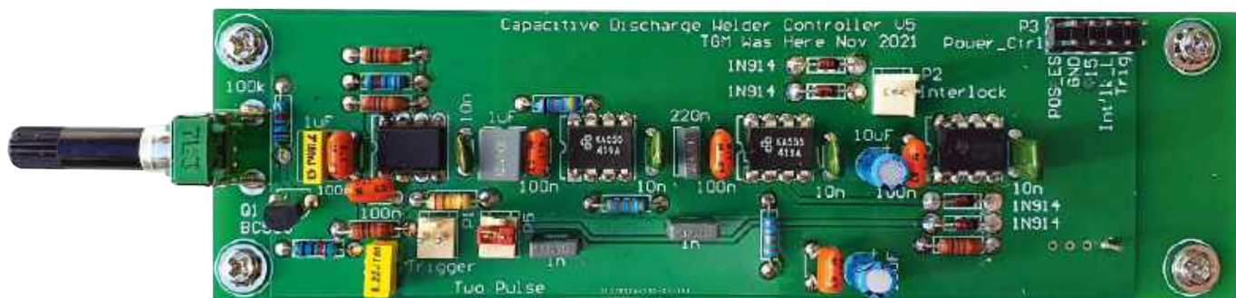
W module sterującym znajdują się cztery układy scalone timera 555
