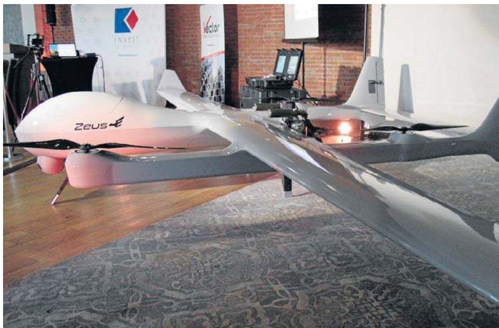
Zeus może wbić się na wysokość 20 tys. stóp (6 tys. metrów) i dysponuje zasięgiem do 3 tys. km - w zależności od tego, co dźwiga i z jaką prędkością się porusza
