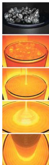
Grafika przedstawiająca przemysłowy proces Czochralskiego służący do uprawy kryształów krzemu
