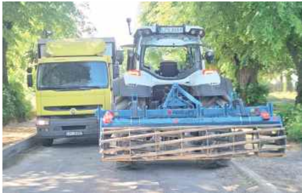
Szerokość ciągnika z agregatem wynosi 3 metry, a obecna szerokość drogi powiatowej 2536L wynosi 5,5 metra, co ewidentnie uniemożliwi wyminięcie się pojazdów
