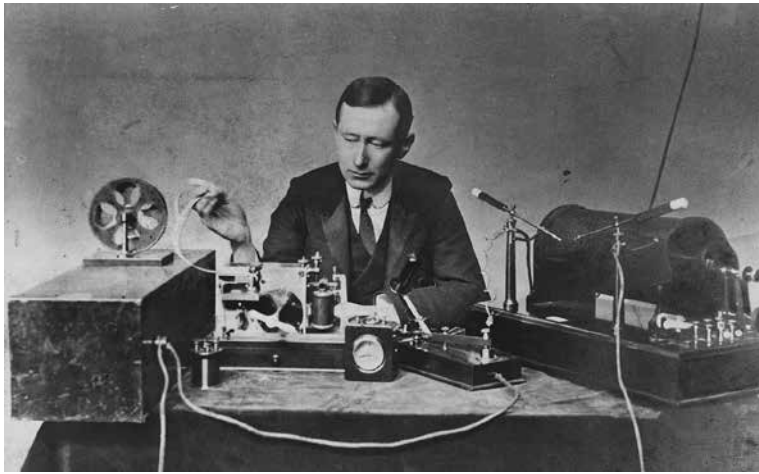
Rok 1901, Marconi; po jego prawej stronie nadajnik iskrowy, po lewej odbiornik na kohererze z zapisem na taśmie papierowej
