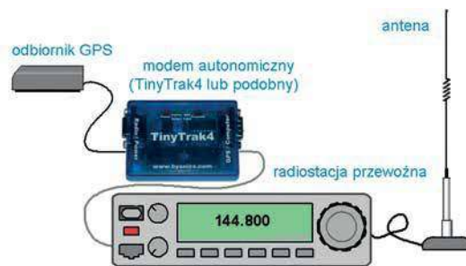
Rys. 3. Wyposażenie stacji ruchomej wyłącznie nadającej komunikaty składa się z radiostacji przewoźnej lub przenośnej, autonomicznego modemu w rodzaju TinyTrak4 i odbiornika
