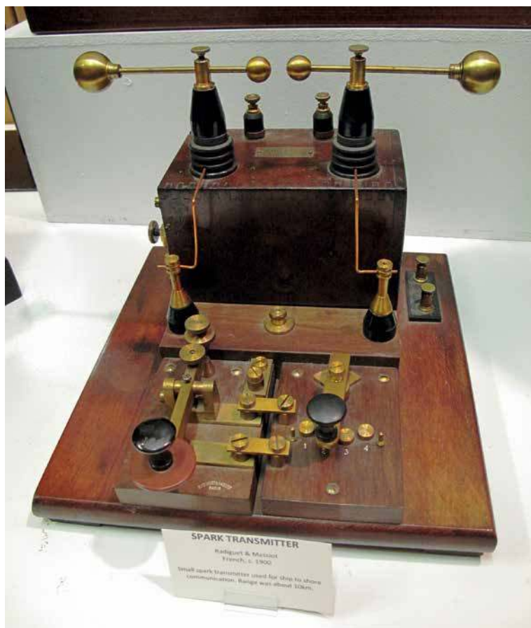
Francuski nadajnik iskrowy Radigue & Massiot z roku 1900
