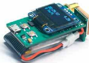
Miniaturowa radiostacja Pico APRS posiada wbudowany modem TNC i odbiornik GPS
