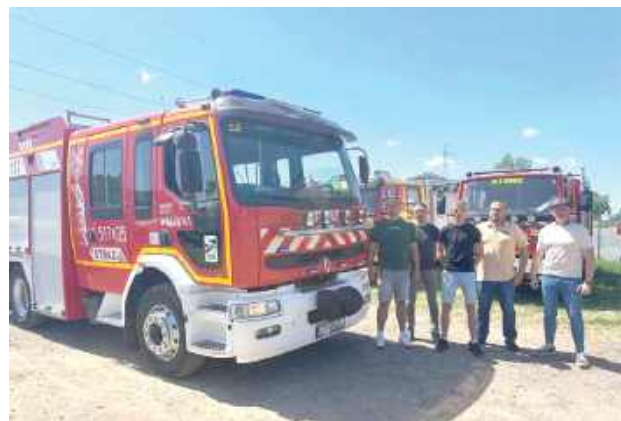
Nowy średni samochód ratowniczo-gaśniczy został wyprodukowany w 2000 roku. Posiada zbiornik na 3000 litrów wody oraz autopompę o wydajności 2000 litrów na minutę. Na wyposażeniu znajdują się także m.in. wyciągarka o uciążu 7,5 tony, agregat prądowórczy oraz nowoczesny maszt oświetleniowy LED
