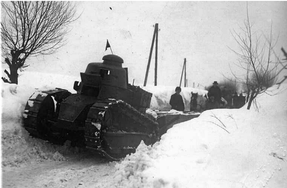
1929 rok, gdzieś pod Przemyślem. Francuskie lekkie czołgi Renault FT17 podczas odśnieżania drogi
