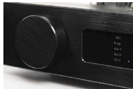
Układ weryfikujący bias lamp wywołujemy przełączając selektor źródeł w skrajne, dolne położenie.
