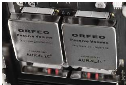
Regulator głośności zaprojektował Auralic, bez użycia gotowych układów scalonych, a tylko przełączników i rezystorów.
