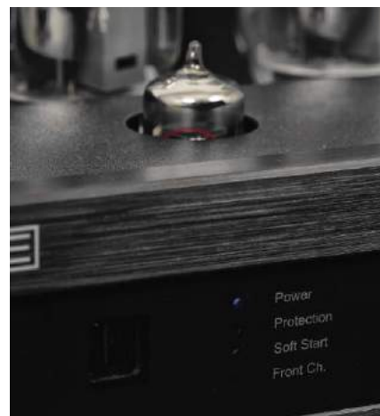
Przygotowano kilka dodatkowych układów, między innymi wydłużający trwałość lamp system tzw. miękkiego startu (soft start).
