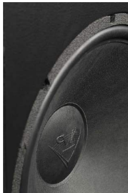
Membrana bierna jest zawieszona na gumie, ułatwiającej ustalenie niskiej częstotliwości rezonansowej. A i tak nie jest ona wcale bardzo niska... Bowiem określa ją nie tylko podatność zawieszon samej membrany, ale i powietrza w obudowie.
