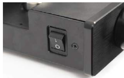
Włącznik zasilania zainstalowano z boku – to całkiem wygodne i już niezaskakujące.
