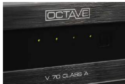
Środek przedniego panelu zajmują oryginalne wskaźniki kondycji lamp i automatycznej kalibracji prądu bias.
