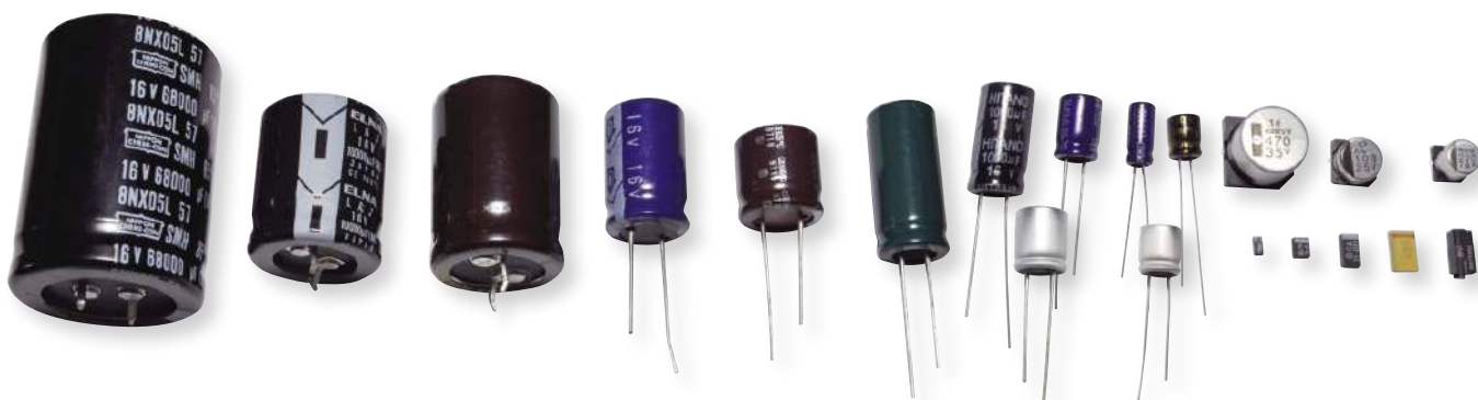
Zestaw kondensatorów elektrolitycznych w zakresie od 10 \mu\text{F} do 68 mF (68 000 \mu\text{F} ). Zwróć uwagę, że kondensatory elektrolityczne typu puszka mają pasek wskazujący końcówkę ujemną, podczas gdy prostokątne kondensatory SMD mają pasek wskazujący końcówkę dodatnią
