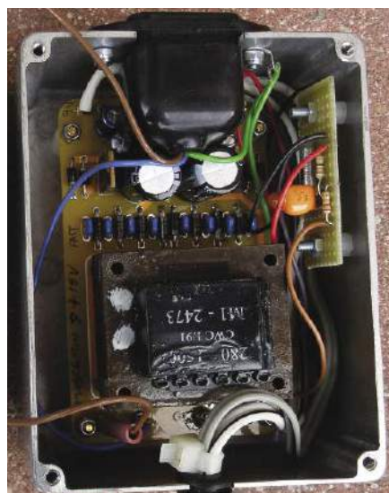
Rysunek 32. Wnętrze zasilacza – mała płytka z boku do Zobel – „zwarowany układ” z części 1
