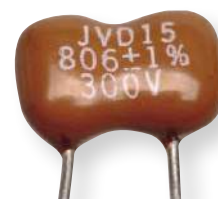
Przykład kondensatora mikrowego 806 pF 300 V. Wartość znamionowa 1% oznacza, że jego rzeczywista wartość będzie w zakresie -798...814 pF
