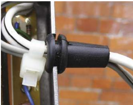
Rysunek 21. Kabel wyjściowy zasilaczy prądu stałego to często dwużyłowy kabel o zaznaczonej polaryzacji (o przekroju przypominającym ósemkę), zwykle tani kabel głośnikowy. Zwróć uwagę na gumową przelotkę
