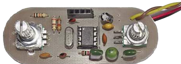
Rysunek 3. Schemat montażowy komponentów na płytce drukowanej, z pasującymi zdjęciami ułatwiającymi montaż. Nie należy montować CON1 i CON2 podczas korzystania z obudowy drukowanej. Połączenie przewodowe (pokazane na czerwono) nie jest potrzebne w przypadku komercyjnych płytek dwustronnych. Wyświetlacz OLED (nie pokazany na zdjęciu po prawej) podłącza się do złącza CON3 po zamontowaniu pozostałych komponentów
