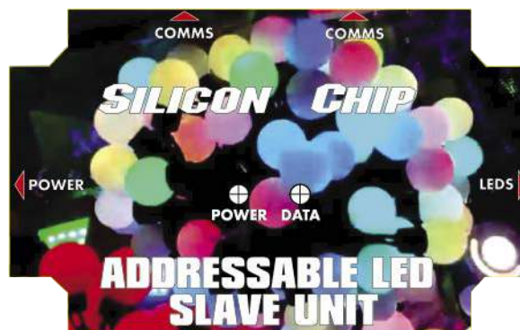
Rysunek 20. Jest to grafika na pokrywę pudełki, która może również służyć jako szablon do wiercenia otworków na diody LED
