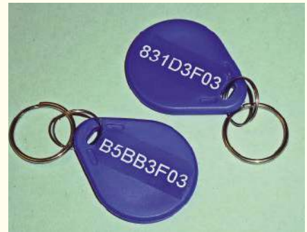
Rysunek 2.11. Tagi RFID oznaczone unikalnymi 64-bitowymi identyfikatorami
