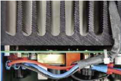
Końcówka mocy to układ tranzystorowy z zaawansowaną korekcją zniekształceń.
