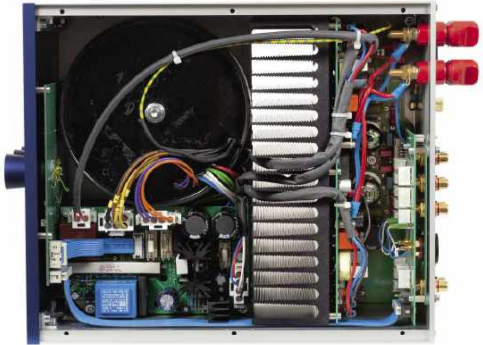
Przednią połowę obudowy zajmuje liniowy zasilacz, tranzystorowe końcówki i lampowy przedwzmacniacz znajdujący się z tyłu.
