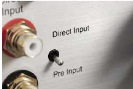
Przełącznik trybów uruchamia bezpośrednie wejście DIRECT (pomijając przedwzmacniacz).
