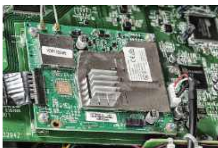
Charakterystyczna ekranowana płytką to centrum dowodzenia systemu HEOS.
