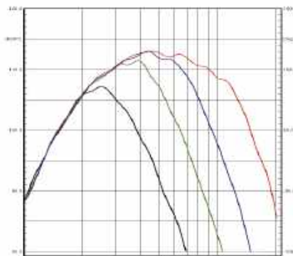
Rys. 2. Charakterystyki dla czterech częstotliwości filtrowania dolnoprzepustowego (30 Hz, 50 Hz, 80 Hz, 160 Hz).
