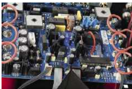
Górna, wyekspozowana płytka zawiera tylko elementy zasilacza układu sterowania.
