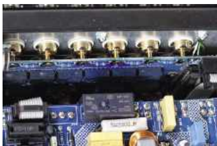
Z tyłu znajduje się tylko część układu przedwzmacniacza, związana z przełączeniem wejść.
