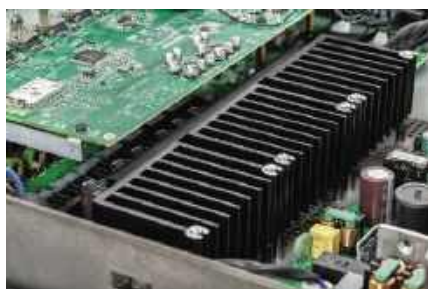
To jeden z nielicznych wzmacniaczy A/V z impulsowymi końcówkami mocy (oraz takim zasilaczem).
