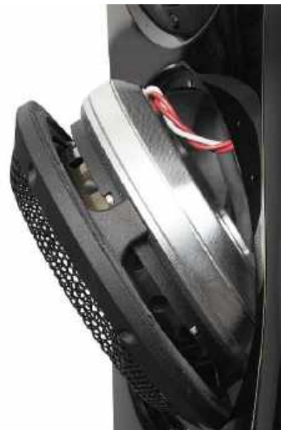
Głośnik średniotonowy 17-cm jest już bardzo "płaski", ma neodymowy układ magnetyczny i cewkę... 114-mm, o średnicy niemal takiej, jak membrana. Tutaj długi karkas o dużej masie znacznie popsułby charakterystykę.
