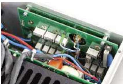
Sygnał z gniazd RCA trafia bezpośrednio na płytkę z selektorami wejść (przełączniki).
