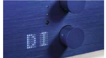
Tryb Direct (bezpośrednie wejście na końcówkę) sygnalizuje napis DI.
