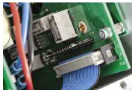
Szeroka taśma służy do przesyłania sygnałów sterujących, nie bieżąco sygnały audio.
