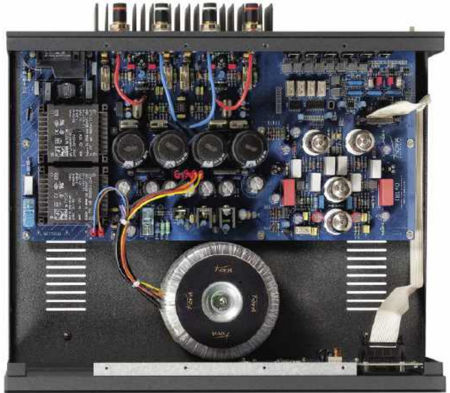
Pomimo rozbudowanego przedwzmacniacza, układy we wnętrzu sprawiają wrażenie kompaktowych; fragment końcówek mocy przeniesiono na zewnętrzny radiator.
