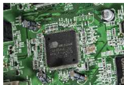
W obszarze dekodera surround Marantz konsekwentnie wykorzystuje układ firmy Cirrus Logic.
