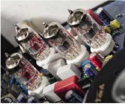
Sygnal o wysokim napięciu dostarcza tercet lamp ECC82/ECC83 JJ Electronic.
