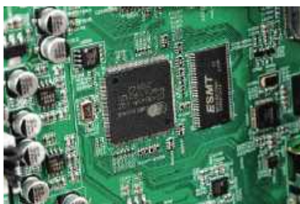
Sekcja cyfrowa wykorzystuje doskonale znane dekodery surround Cirrus Logic.
