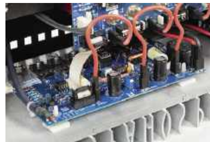
Płytki z końcówkami mocy przykręcono do bocznych radiatorów.
