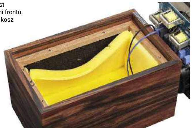
Tak jak pół wieku temu, obudowa jest wykonana z 12 mm sklejki brzoazowej, wytlumiona matami bitumicznymi i gąbką.
