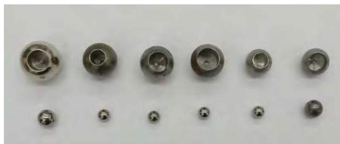
Fot. 2. Przykłady zestawów złożonych z większych kulek z wywierconym otworem i mniejszych kulek przeznaczonych do badania zderzeń.
