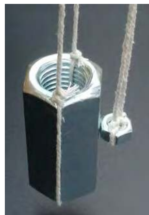
Fot. 1. Jeden z wykonanych układów nakrętek o znacznie różniących się masach.
