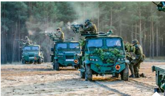
Ramowa konstrukcja, wypróbowany napęd, aluminiowe nadwozie wzmocnione stalową klatką rurową, wysokiej jakości materiały mają zapewnić długotrwałą i niezawodną eksploatację AERO w Siłach Zbrojnych RP | fot. Wojsko-polskie.pl/d
