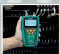
pomiar długości przewodu; lokalizacja punktu przerwania
