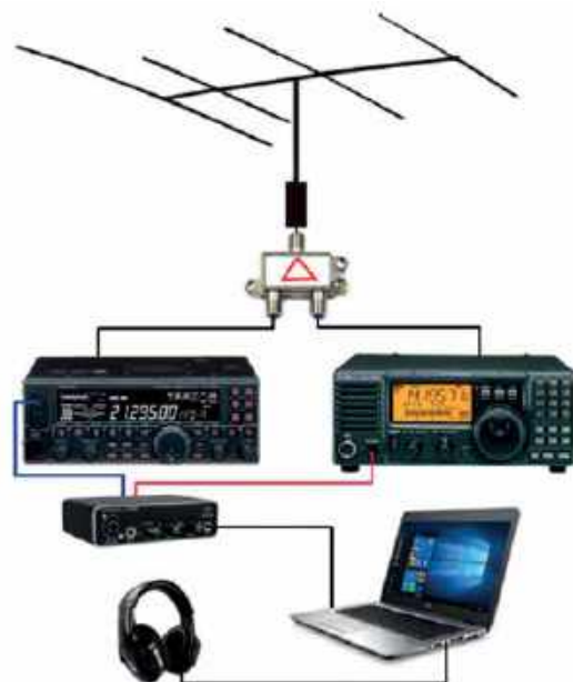
Rys. 14. Schemat blokowy podłączenia interfejsu
