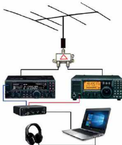
Rys. 14. Schemat blokowy podłączenia interfejsu
