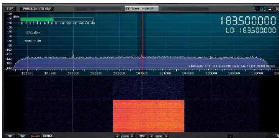
Rys. 11. Filtr notch dla pasma DAB+
