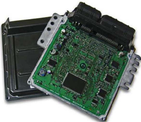
Fotografia 6. Wygląd i budowa sterownika ECU
