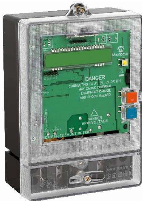
Fotografia 2. Widok cyfrowego licznika energii elektrycznej zbudowanego według dokumentacji z noty aplikacyjnej DS51931A firmy Microchip ( https://t.ly/iGib )
