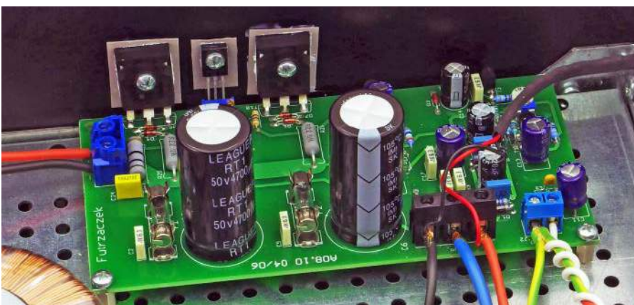
Fotografia 4. Szczegóły montażu zmontowanych płytek w obudowie płytki wzmacniacza
