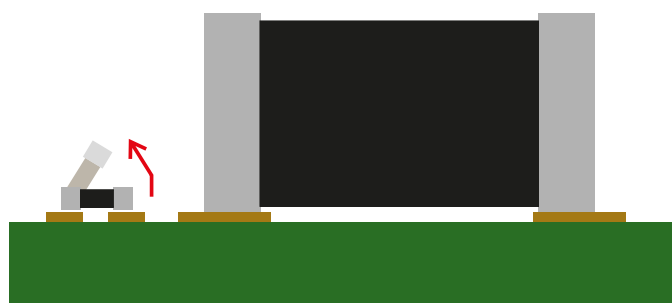
Rysunek 10. Efekt nagrobkowania ( tombstoning ) spowodowany zróżnicowaniem pojemności cieplnej w otoczeniu drobnego elementu SMD ( https://t.ly/7vYJ )
