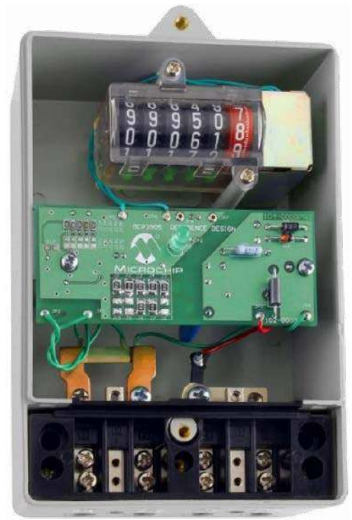
Fotografia 1. Aplikacja prostego licznika energii zbudowanego na bazie front-endu MCP3905A ( https://t.ly/p50F )
