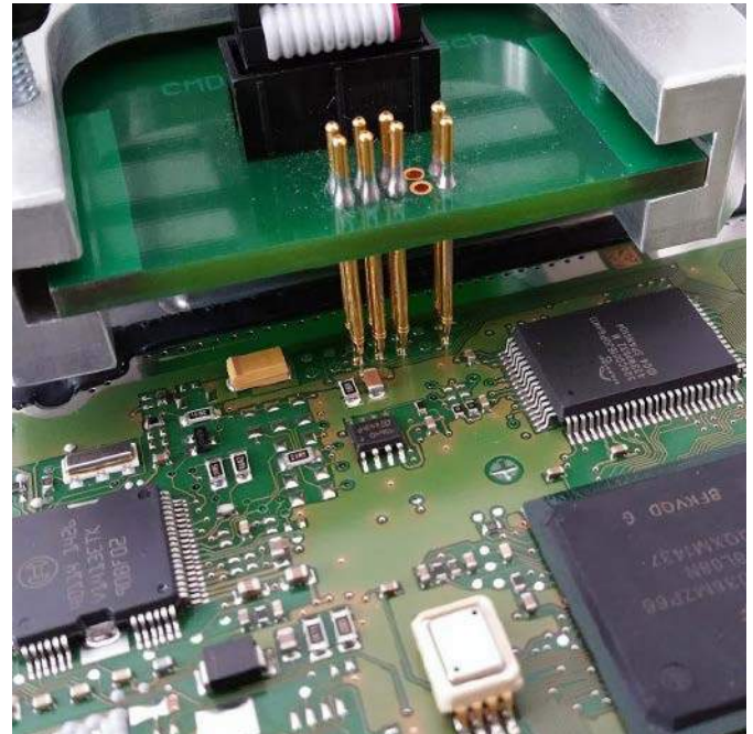
Fotografia 7. Sposób dołączenia do interfejsu BDM
