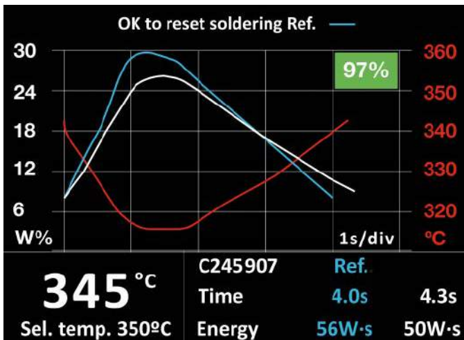
Rysunek 2. Przebieg procesu lutowania oraz wszystkie ustawienia zobrazowane na kolorowym wyświetlaczu graficznym
