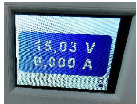
Fotografia 4. Wygląd głównego okna zasilacza – wyświetlane jest aktualne napięcie i pobór prądu
