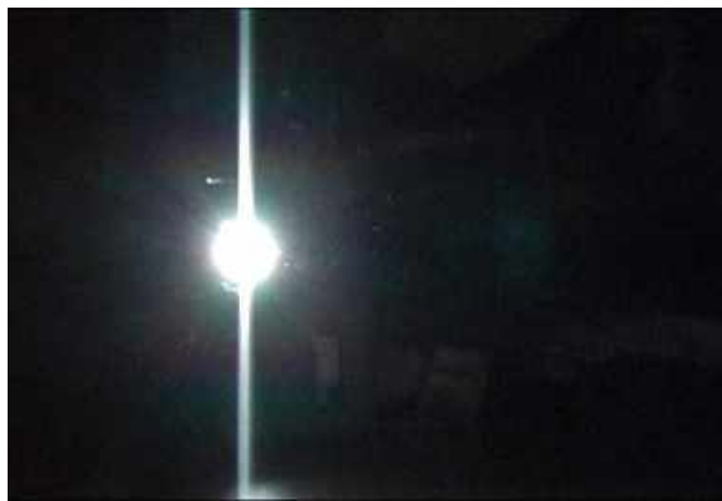
Fotografia 5. Ilustracja artefaktu określanego jako smearing , występującego w matrycach CCD FT ( http://t.ly/oyzPe )
