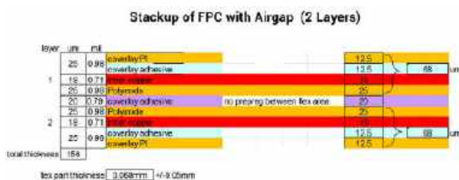
Rysunek 2. Budowa stosu 2-warstwowego obwodu elastycznego ze szczeliną powietrzną
