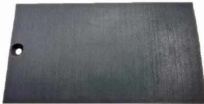
Fotografia 4. Widok dolnej części obudowy (klapki) urządzenia cMeter wydrukowanej w technologii SLA
