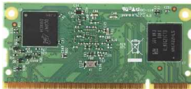
Fotografia 4. Moduł SoM Raspberry Pi Compute Module 3+, wyposażony w pamięć DDR2 produkcji Micron – układ U2 ( http://t.ly/SYEsn )
