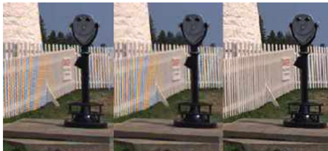
Fotografia 12. Przykłady artefaktów powstających w wyniku demozaikowania algorytmami nieprzystosowanymi do pracy z obrazami o wysokiej częstotliwości przestrzennej szczegółów. Lewy obraz: demozaikowanie algorytmem najbliższego sąsiada – widoczne zniekształcenia chromatyczne i efekt zippering (kolorowego, naprzemiennego zafalowania krawędzi); środkowy obraz: efekt uzyskany przy zastosowaniu algorytmu interpolacji dwuliniowej, widoczne zniekształcenia kolorystyczne; prawy obraz: efekt uzyskany w wyniku demozaikowania algorytmem typu adaptive homogeneity-directed ( http://t.ly/oenEQ )
