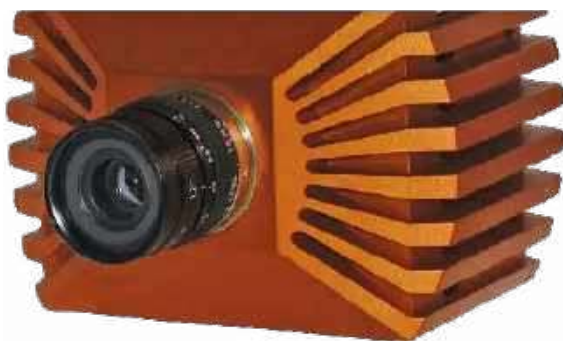
Fotografia 7. Przykładowa kamera typu EMCCD ( http://t.ly/f7grW )
