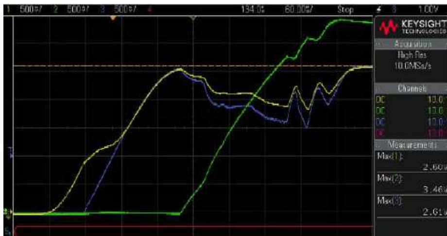
Rysunek 4. Start pracy z zasilaniem z gniazdka BATT z wciśniętym przyciskiem POKE
