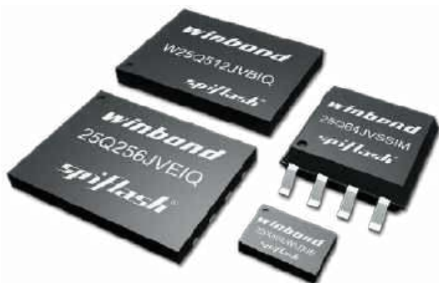
Fotografia 1. Układy pamięci NOR Flash produkcji Winbond ( http://t.ly/xvqOr )
