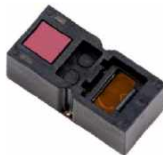
Fotografia 22. Sensor VL53L9CA marki STMicroelectronics ( http://t.ly/OMcC7 )
