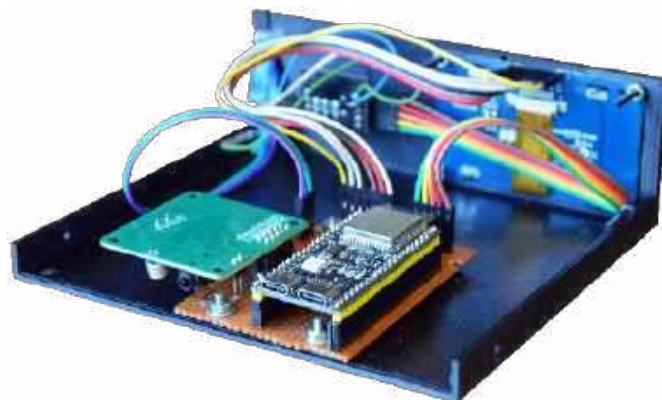
Fotografia 3. Prototyp w trakcie budowy
