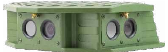
Fotografia 5. Głowica optoelektroniczna KTD-90.3 Argos
