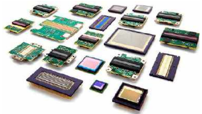
Fotografia 4. Przykładowe czujniki obrazu marki Teledyne ( http://t.ly/Hb9Gh )
