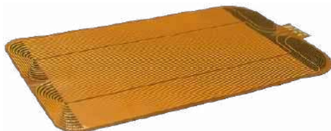
Fotografia 2. Dwuwarstwowy obwód drukowany na podłożu elastycznym
