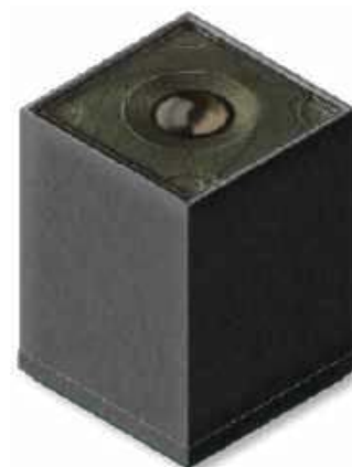
Fotografia 20. Moduł kamery OCH2B10 marki OMNIVISION ( http://t.ly/kTJoz )
