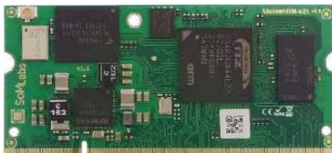
Fotografia 6. Moduł SoM firmy SomLabs wyposażony w pamięć RAM 1 GB typu DDR4, pamięć eMMC o pojemności 32 GB oraz pamięć Flash QSPI (http://t.ly/CVdwb)
