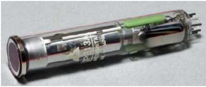
Fotografia 2. 17-milimetrowa lampa analizująca typu Vidicon ( http://t.ly/JAYOW )
