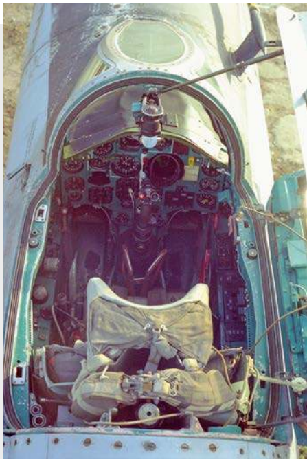
Kabina pilota samolotu MiG-25PDS z odchylaną na prawo częścią ruchomą – po lewej i po prawej – kokpit pilota MiG-a-25PDS.
