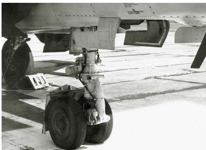
Podwozie przednie MiG-a-25 jest sterowane, z dwoma kołami o wymiarach 700 × 200 mm.
