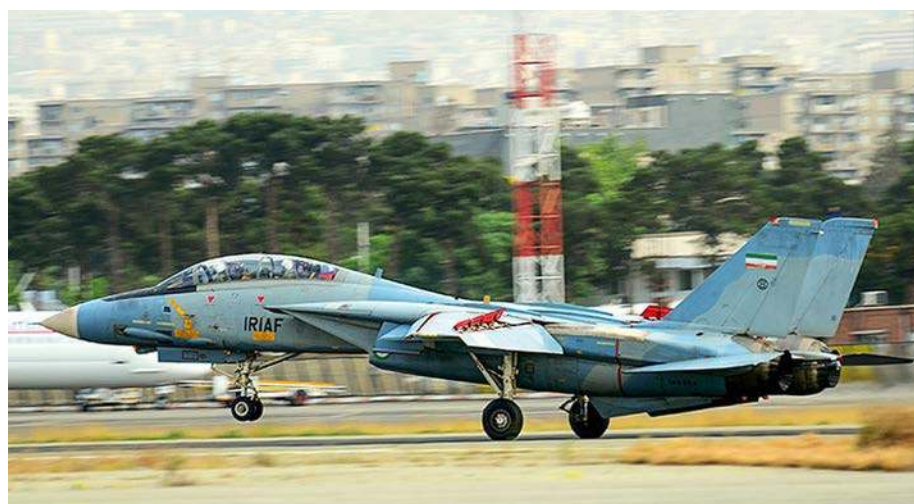
Od początku minionej dekady część pozostałych w służbie maszyn zmodernizowano do standardu F-14AM, przy czym zastosowano nowy jasny kamuflaż.
