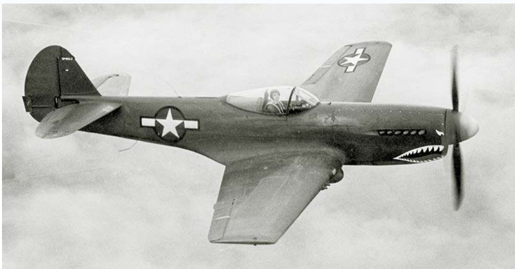
Pierwszy prototyp XP-40Q w finalnej konfiguracji oznaczony jako XP-40Q-2 – z silnikiem V-1710-121 i „obcięty” końcówkami skrzydeł.
