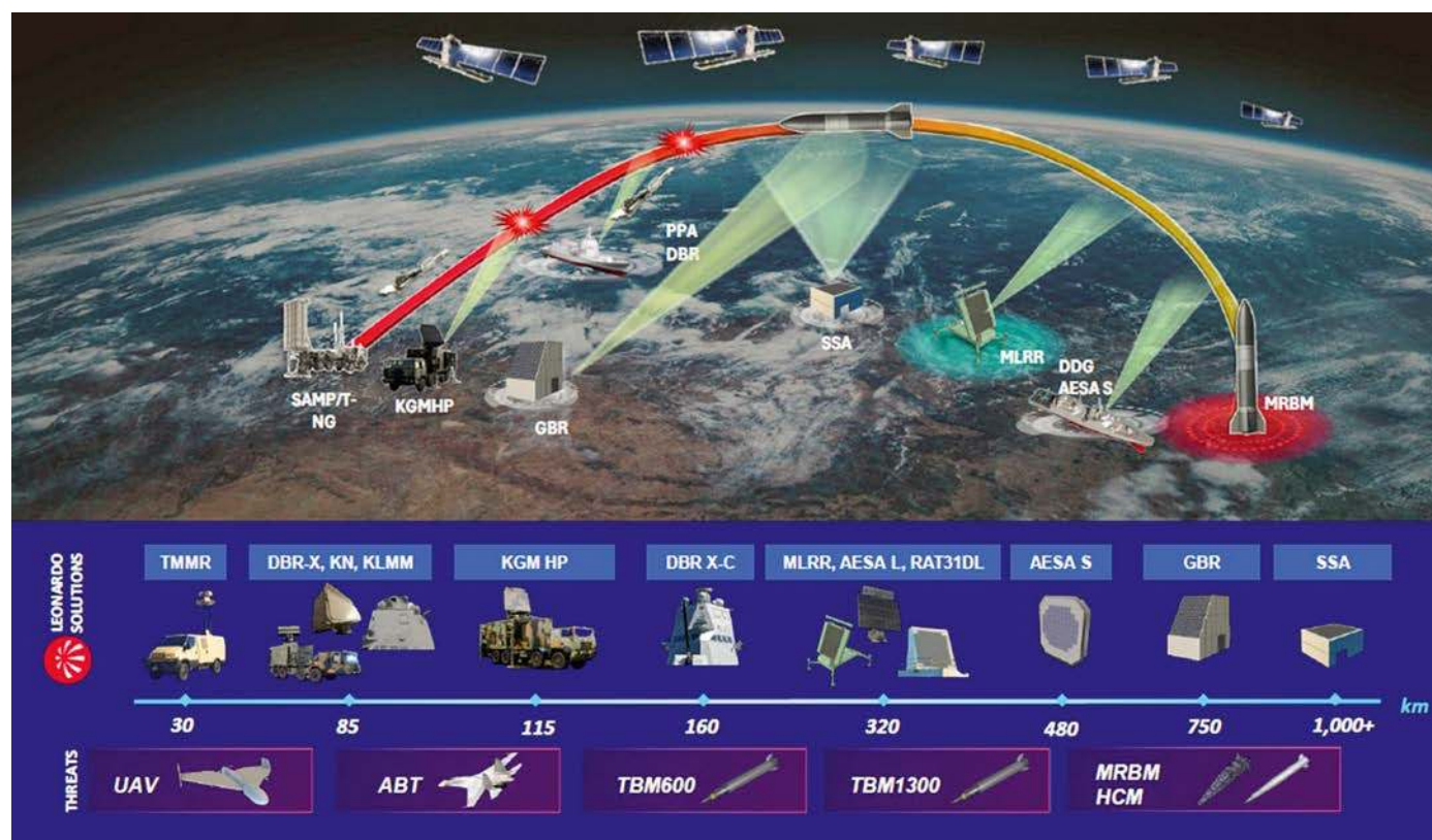
Schemat działania systemu Michelangelo Dome w warstwie zdolnej zwalczać zagrożenia balistyczne.
