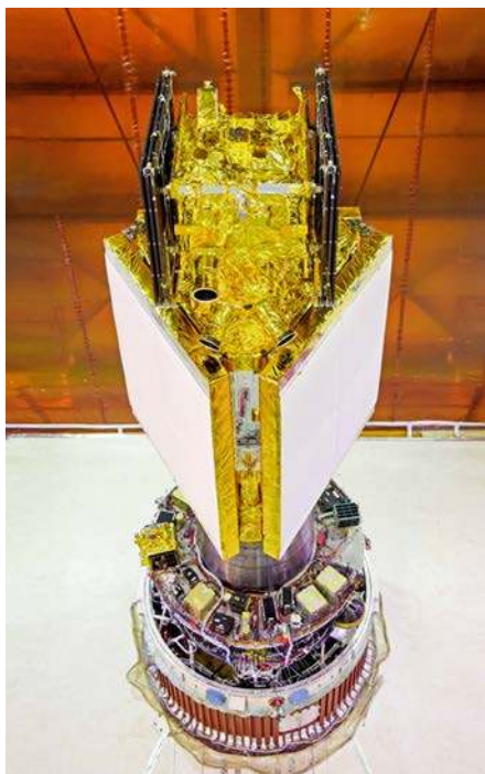
Satelita wyposażony w radar z syntetyczną aperturą RISAT-1 przygotowany do wyniesienia w przestrzeń kosmiczną przez raketę nośną. Misja została przeprowadzona w 2012 roku przez Indyjską Organizację Badań Kosmicznych. RISAT-1 był pierwszym obiektem kosmicznym przyczyniającym się do rozbudowy indyjskiej konstelacji satelitarnej oraz inicjującym zwiększenie aktywności Indii w kosmosie.
