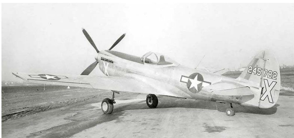
Drugi prototyp XP-40Q-2A powstał z przebudowy pierwszego seryjnego egzemplarza P-40K-1 (42-45722). Był niemal identyczny z XP-40Q-2 w finalnej konfiguracji poza tym, że zastosowano automatyczną regulację żaluzji chłodnic cieczy i oleju.
