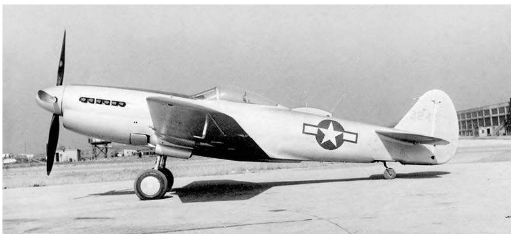
Trzeci prototyp XP-40Q-3 powstał z przebudowy P-40N-25 (43-24571). W porównaniu z XP-40Q-2 i -2A zastosowano mniejszą osłonę kabiny z płaską przednią szybą wiatrochronu nachyloną pod większym kątem.
