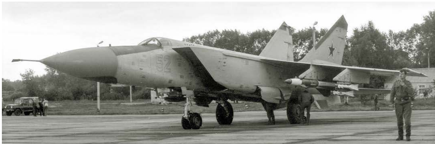
MiG-25PDS z podwieszonymi pociskami R-40RD (na wewnętrznych węzłach) i R-60M (na zewnętrznych węzłach, na podwójnych prowadnicach).
