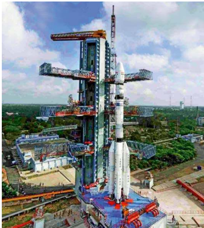
Przygotowania do lotu indyjskiej rakiety nośnej z serii GSLV, której zadaniem było wyniesienie satelity GSAT-6, zapewniającego usługi komunikacyjne w paśmie S. Po separacji w kosmosie obiekt kontynuował lot samodzielnie do docelowego punktu, czyli na orbitę geostacjonarną, zostając na 83°E. Fot. ISRO/Government of India
