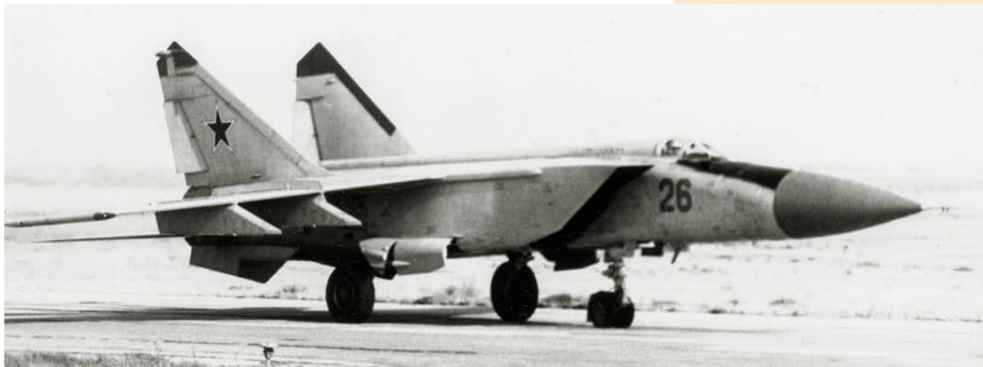
Do podwieszania pocisków R-40 (będących jedynym uzbrojeniem MiG-a-25P) służyły cztery duże pylony pod skrzydłami.
