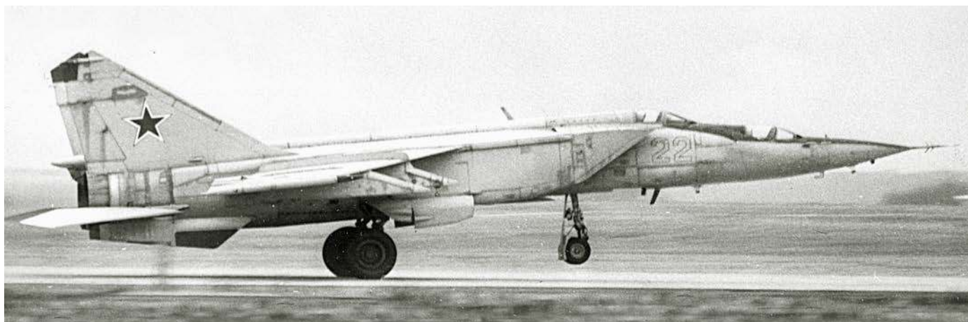
Samolot MiG-25PU-SOTN wykorzystano do opracowania algorytmów sterowania wahadłowcem kosmicznym Buran podczas podejścia do lądowania.
