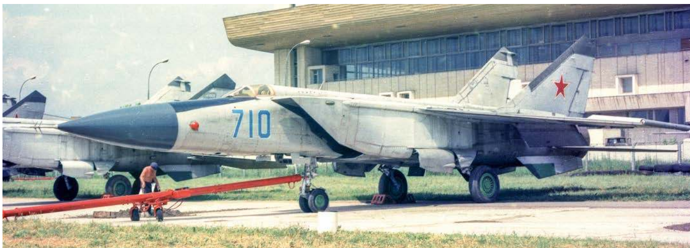
MiG-25M różnił się od seryjnych MiG-ów-25P szeregiem dopracowanych detali płatowca (częścią nosową, końcówkami skrzydeł, lotkami) oraz potężniejszymi silnikami R15BF2-300.
