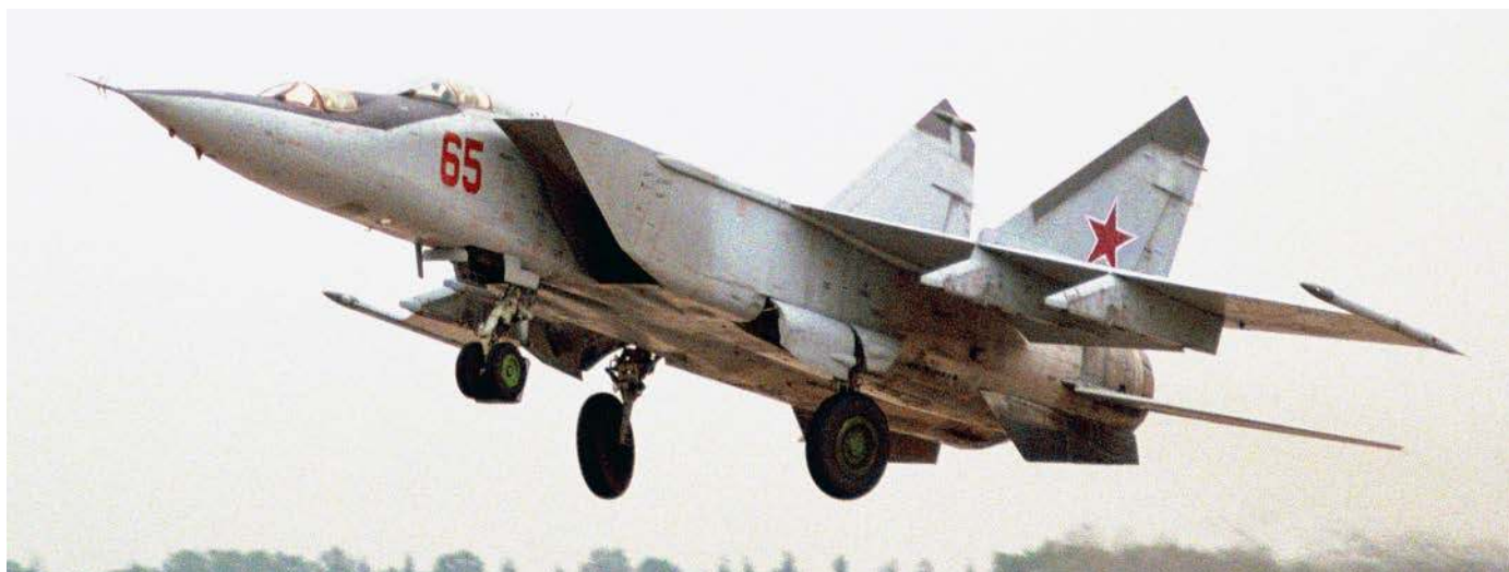
Szkolny MiG-25PU miał cztery pylony do podwieszania pocisków R-40. Ze względu na brak radaru mógł jednak używać wyłącznie ich wersji z termicznymi głowicami samonaprowadzającymi.
