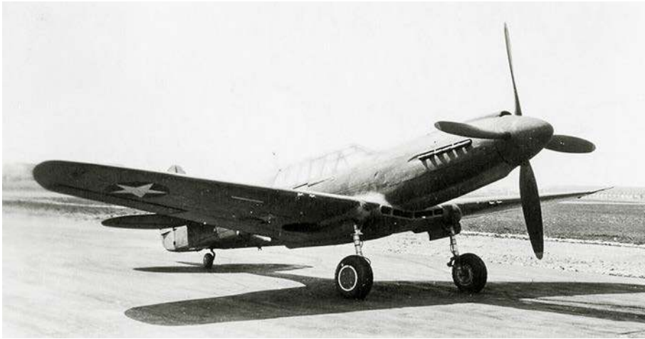
Pierwszy prototyp XP-40Q w początkowej konfiguracji – z silnikiem V-1710-101 i chłodnicami cieczy i oleju umieszczonymi pod kadłubem i przykadłubową częścią skrzydeł. Samolot powstał z przebudowy P-40K-10 (42-9987).
