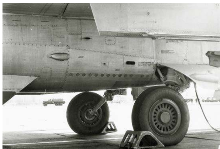
Podwozie główne ma pojedyncze koła o wymiarach 1300 × 360 mm. Wąskie opony uniemożliwiały operowanie z lotnisk nieutwardzonych. Nawet lądowanie awaryjne na takim lotnisku prowadziło do utraty podwozia.
