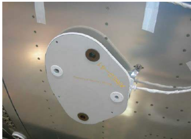
Fotografia 13. Jedna z anten ARISS, opracowanych przez zespół naukowców z Politechniki Wrocławskiej na potrzeby Międzynarodowej Stacji Kosmicznej ISS ( https://t.ly/fSyM )
