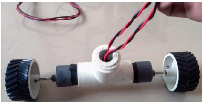
Fotografia 2. Zmontowane podwozie robota
