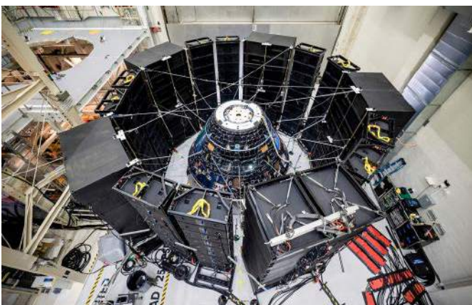
Fotografia 5. Mobilne stanowisko MSI-DFAT przeznaczone do realizacji testów wibroakustycznych. Widoczne potężne kolumny głośników elektrodynamicznych ustawione wokół testowanego obiektu ( https://t.ly/mKq1 )
