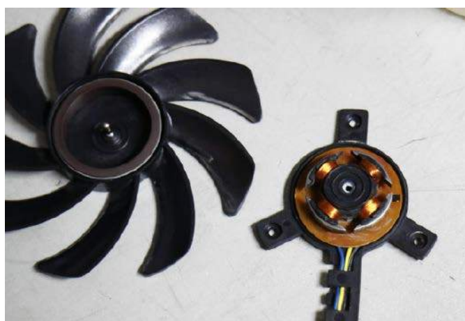
Fotografia 2. Konstrukcja jednofazowego silnika BLDC
