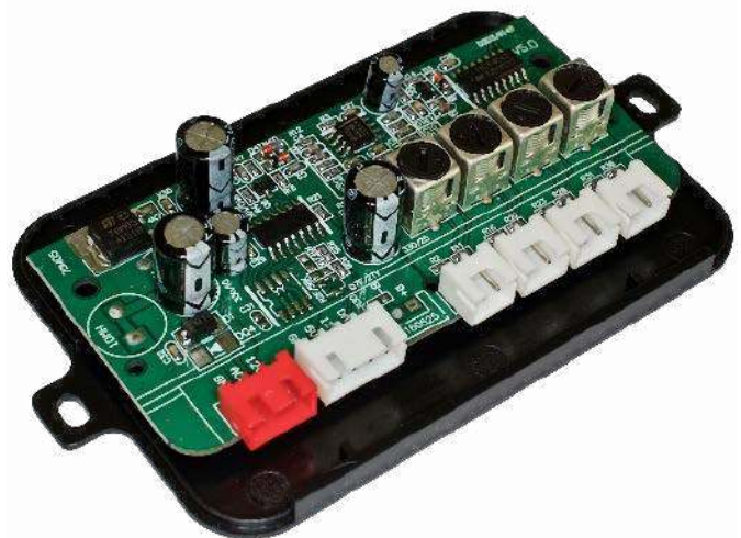
Fotografia 4. PCB systemu czujników parkowania z widocznymi transformatorami IFT przeznaczonymi do obsługi czterech kanałów pomiarowych ( https://t.ly/Kdza )
