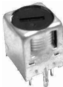
Fotografia 3. Przykładowy transformator IFT – TS7231-2 marki Osenon Technology ( https://t.ly/-UPQ )
