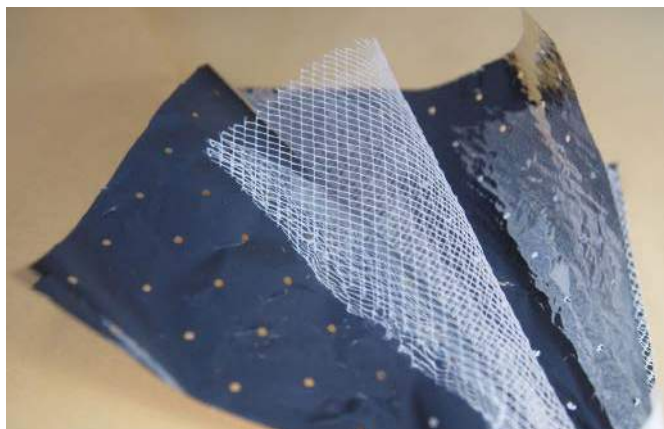
Fotografia 8. Część wewnętrznych warstw osłony termicznej z wiodoczną siatką oraz perforowanymi warstwami: grubszą, zewnętrzną (po lewej) oraz cieńszą wewnętrzną (w po prawej) ( https://t.ly/RX7K )
