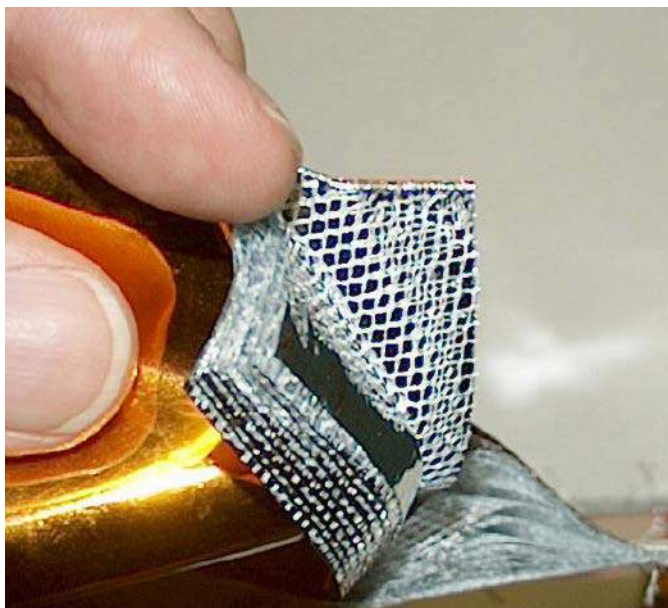
Fotografia 6. Widok przykładowej osłony MLI po rozwarstwieniu ( https://t.ly/RbX_ )
