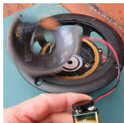
Rysunek 23. Wyskakująca membrana głośnika. Dodatnie napięcie przyłożone do luźnej membrany powoduje jej wyskoczenie.
