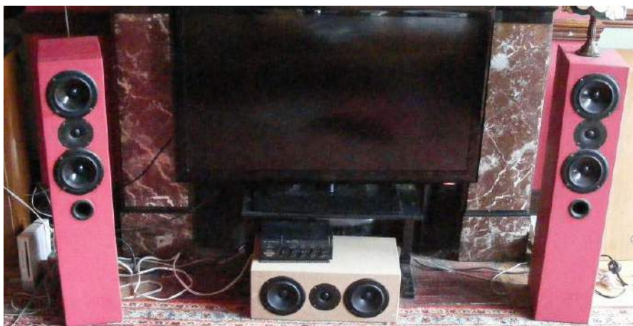
Rysunek 45. Jeśli nie lubisz standów, a chcesz uzyskać lepszy bas, skuteczne są kolumny podłogowe, takie jak na zdjęciu. Głośnik centralny powinien być jednak na stojaku.
