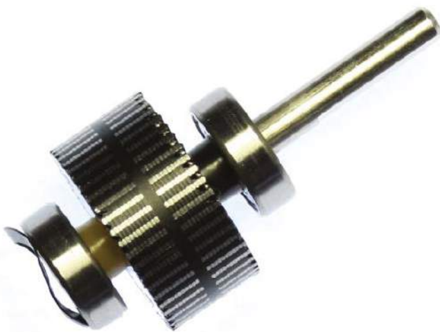
Rysunek 3. Wirnik hybrydowego silnika krokowego NEMA 17 z silnika o 200-krokach z widocznymi dwoma sekcjami wirnika, każda po 50 zębów. Przyjrzyj się uważnie, a powinieneś zobaczyć, że zęby obu sekcji wirnika są przesunięte względem siebie o pół skoku (3,6°), tworząc efektywnie wirnik o 100 zębach.
