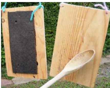
Rysunek 46. Demonstracja tłumionych (po lewej) i nietłumionych (po prawej) paneli ze sklejk (zainspirowana starym wykładem KEF-a).
