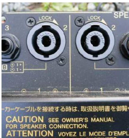
Rysunek 39. Gniazda Speakon na wzmacniaczu mocy Yamaha. Wtyki należy obrócić po wpięciu do gniazd, aby zablokować połączenie.
