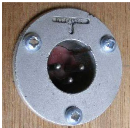
Rysunek 35. 3-pinowe gniazdo XLR w starym BBC LS3/5A.
