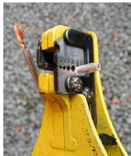
Rysunek 29. Zwróć uwagę, że okrągłe ostrza ściągacza izolacji Rolsona nie nacinają żył kabla CPC z rysunku 26.
