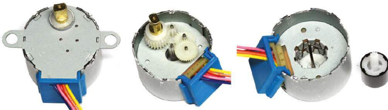
Rysunek 2. Widok wewnętrzny silnika krokowego z magnesem trwałym 28BYJ-48 z wbudowaną przekładnią. Należy zwrócić uwagę na 'palce' wokół wewnętrznej strony stojana dające 32 kroki na obrót. Liczba kroków na wale wyjściowym wynosi w przybliżeniu* 32 x przełożenie przekładni 64 = 2048 w trybie full-step. (*uwaga, że przełożenie przekładni nie wynosi dokładnie 64:1).
