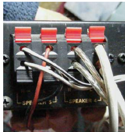
Rysunek 34. Zaciski sprężynowe są często stosowane do głośników w tanim sprzęcie; na przykład w tej skrzynce przetwarzającej głośniki.
