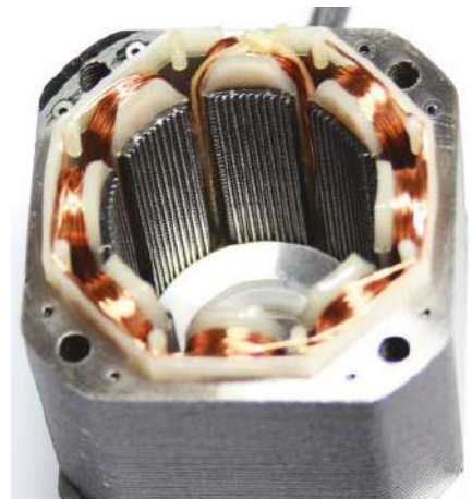
Rysunek 6. Wnętrze wirnika 400-krokowego silnika bipolarnego NEMA 17, podobnie jak jego stojan, również ma zwiększoną liczbę zębów w porównaniu do 200-stopniowego stojana z rysunku 4.
