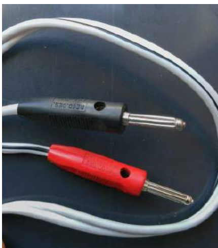
Rysunek 25. Standardowy kabel głośnikowy na wzór stygnego QED 79 firmy Pro Power. Zwróć uwagę na pasek polaryzacji. 79 żył miedzi o przekroju 0,17 mm 2 daje CSA 2,4 mm 2 i rezystancję 0,11 Ω na 10 m przewodu.
