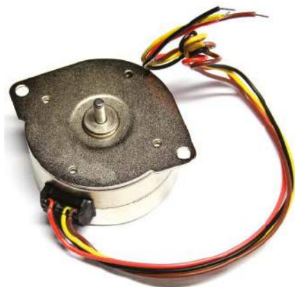
Rysunek 1. 48-krokowy bipolarny silnik krokowy z magnesem trwałym w dwóch „puszkach”.
