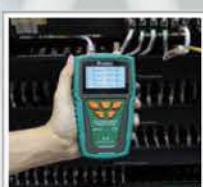
pomiar długości przewodu; lokalizacja punktu przzerwania
