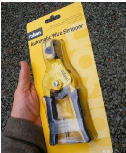
Rysunek 28. Takie ściągacze izolacji z marek budowlanych są doskonałe do kabli głośnikowych, jak również do okablowania domowego.
