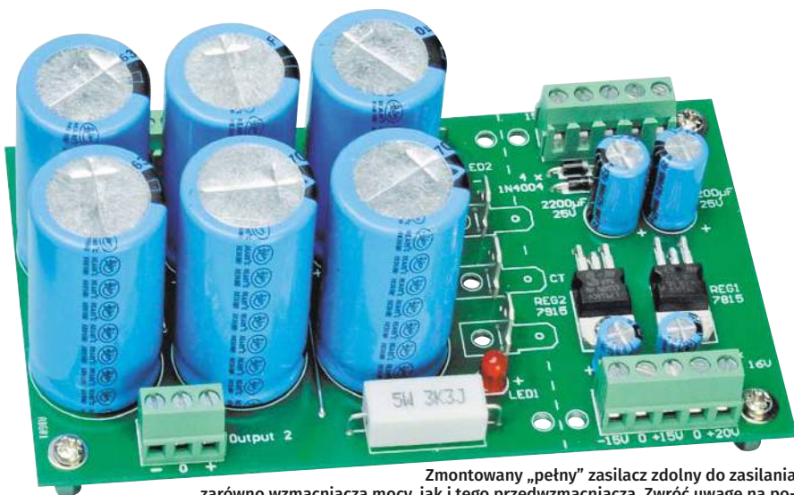
Rysunek 16. Oto sposób mocowania męskich pojedynczych końcówek konektorowych do płytki drukowanej zasilacza. Można również zastosować konektory pionowe z lutowanymi stykami.
