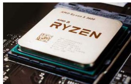
Rysunek 10. Mikroprocesor Ryzen 5 zawiera 4,7 miliarda tranzystorów
