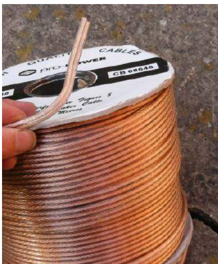
Rysunek 26. Kabel głośnikowy w bezbarwnej izolacji. Pro Power CPC CB08648 1,5mm 2 , 196 x 0,1mm.
