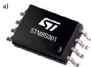
Rysunek 9. a) 8-pinowy mikrokontroler STM8S001, b) przypisanie peryferiów/portów do wyprowadzeń w układzie STM8S001J3
