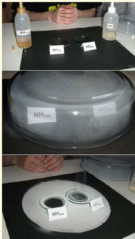
Fot. 3. Doświadczenie 10. Powstawanie chlorku amonu z amoniaku i chlorowodoru.
