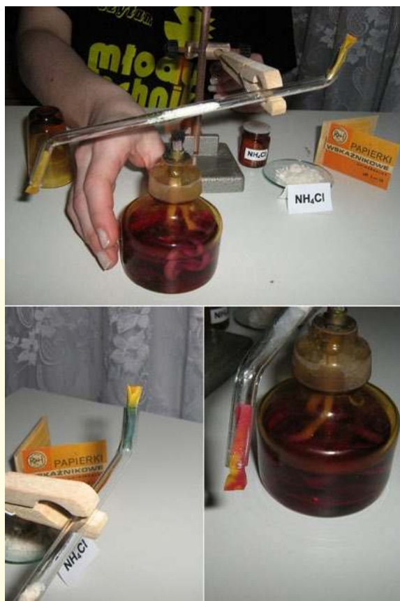
Fot. 4. Doświadczenie 11. Termiczny rozkład chlorku amonu na amoniak i chlorowódor.
