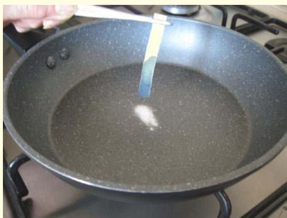
Fot. 5. Doświadczenie 12. Barwa papierka wskaźnikowego dowodzi wydzielania amoniaku podczas termicznego rozkładu „amoniaku do wypieków”.
