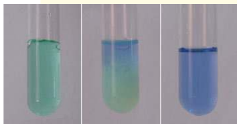
Fot. 1. Doświadczenie 8. Od lewej: akwakompleks niklu(II), po dodaniu wody amoniakalnej najpierw wytrąca się osad hydroksosoli, dalszy dodatek amoniaku powoduje powstanie aminokompleksu.
