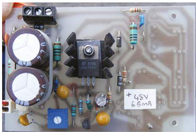
Fotografia 22. Wersja jednoszynowa 48 V niskoprądowa do zasilania phantomowego mikrofonu. W tej konstrukcji pominięto układ środkowej szyny. Wysokie napięcie wymaga zabezpieczenia w postaci diod Zenera i rezystorów. Zwróć uwagę na połączenie dla pracy jednoszynowej (górna prawa strona) i PTC (dolna lewa strona)
