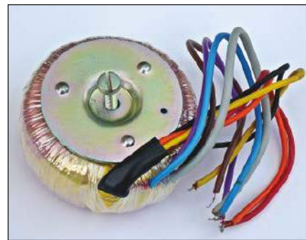
Rysunek 2.9. Kompaktowy transformator toroidalny o mocy 30 VA z podwójnym uzwojeniem pierwotnym 115 V i podwójnym uzwojeniem wtórnym 12 V. Każde uzwojenie wtórne jest przystosowane do obciążenia prądem 1,25 A
