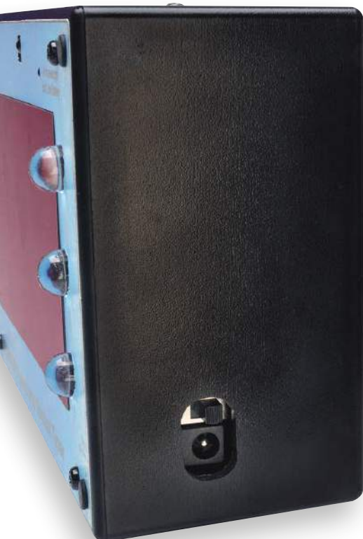
Na prawej ścianie bocznej obudowy wycięty jest otwór umożliwiający dostęp do gniazda prądu stałego i wyłącznika
