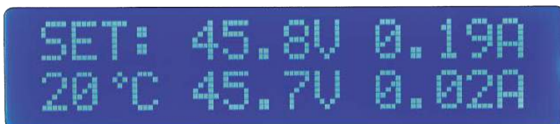
Po skonfigurowaniu jako miernik panelowy wyświetlacz powinien wyglądać tak, jak tutaj, wskazując odczyty napięcia, prądu i temperatury. Jeśli urządzenie jest używane jako wyświetlacz USB, ekran będzie pusty do czasu otrzymania danych z komputera przez port szeregowy USB
