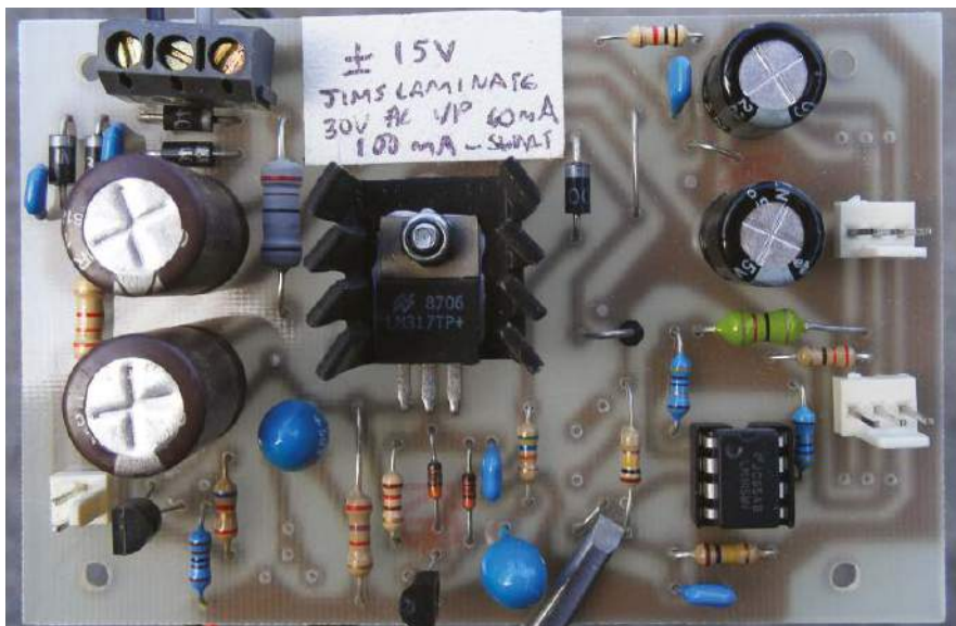
Fotografia 20. Standardowa wersja zasilacza niskopoziomowego \pm 15 V. Ograniczenie małego prądu do 100 mA chroni twoje wzmacniacze operacyjne
