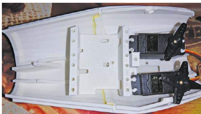
Rysunek 2. Proteza ręki z serwomechanizmem
