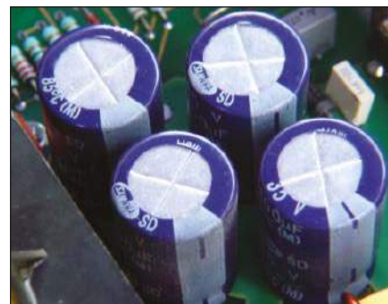
Rysunek 2.17. Jako kondensatora magazynującego używa się czterech dużych kondensatorów elektrolitycznych połączonych równolegle w połączeniu z mostkiem diodowym pokazanym na rysunku 2.16. Każdy kondensator ma pojemność 220 \mu\text{F} i napięcie 450 V
