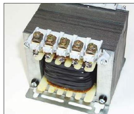
Rysunek 2.7. Ukończony transformator 50 VA. Do uzwojenia wtórnego o napięciu znamionowym 25 V i prądzie 2 A użyto emaliowanego drutu miedzianego o średnicy 1,2 mm
