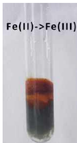
8. Wodorotlenek żelaza(II) szybko utlenia się do wodorotlenku żelaza(III)
