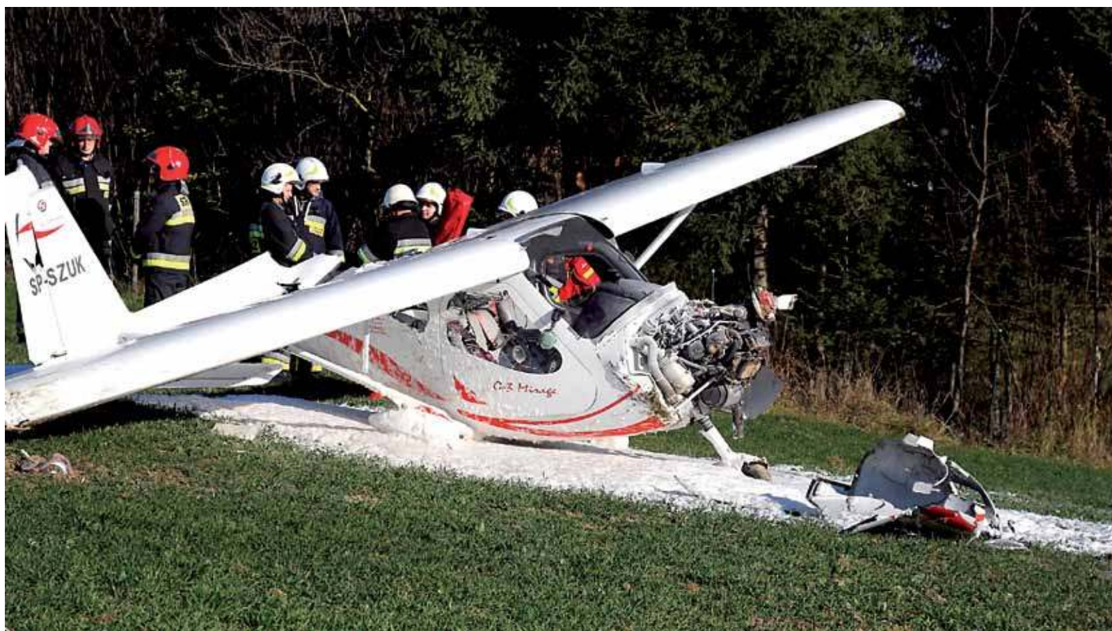
Samolot ma rozbity przednią część kadłuba, uszkodzone skrzydła i połamaną belkę ogonową.
