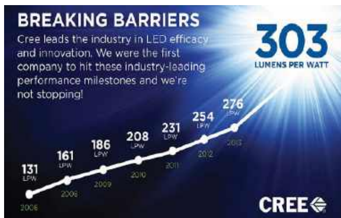
Rysunek 17. Ewolucja skuteczności świetlnej diod LED na przestrzeni niecałej dekady ( http://t.ly/KcPk2 )
