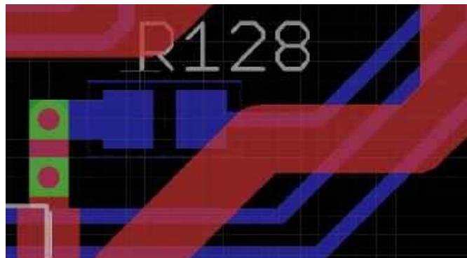
Rysunek 1. Rezystor 0 Ω włączony szeregowo z linią zasilającą układ scalony
