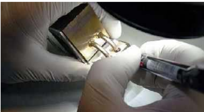
Fotografia 20. Montaż bloku chłodzącego modułu z fotografii 19 ( http://t.ly/lcAEw )
