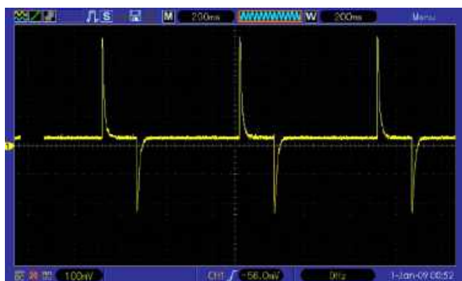
Rysunek 5. Ciąg impulsów zasilających cewkę głośnika
