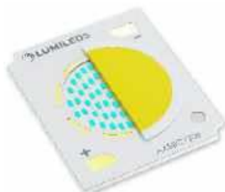
Rysunek 1. Budowa modułu LED COB (za: http://t.ly/us0Jf )
