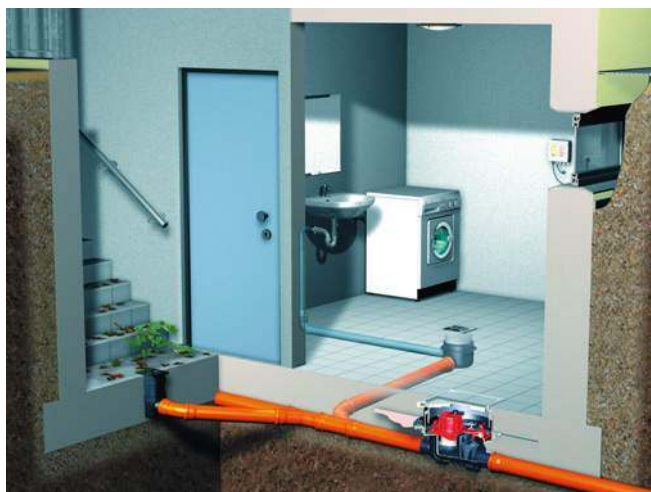
⚙️ Automatyczne urządzenia przeciwzalewowe zapobiegają cofnięciu się ścieków z instalacji do domu. Dzięki nim nie musimy obawiać się zalania piwnic nieczystościami. KESSEL
