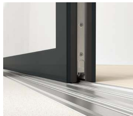
Niski próg zrobiony jest z profili aluminiowych albo PVC, które mają tak wyprofilowany spadek, że płynnie łączą się z posadzką tarasu. ALUPLAST
