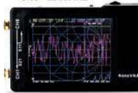
NANOVNA H ANALIZATOR ANTENOWY: 0.05 - 1500MHZ
