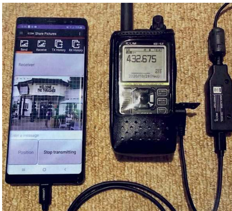
Fot. 1. Minimalne wyposażenie do transmisji obrazu D-STAR nie zajmuje dużo miejsca
