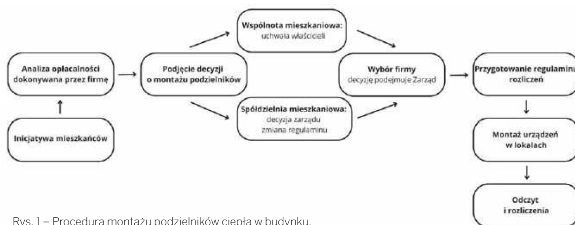
Rys. 1 – Procedura montażu podzielników ciepła w budynku.
