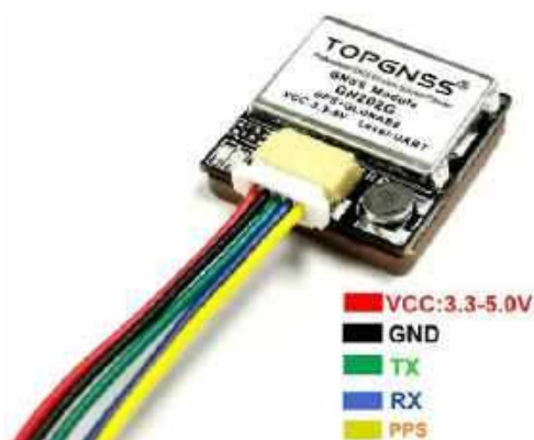
Fotografia 3. Moduł GNSS, który komunikuje się z układem nadrzędnym poprzez interfejs USART ( https://t.ly/Bvy2r )
