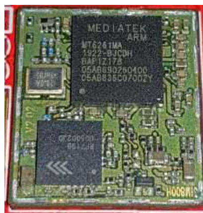
Fotografia 4. Widok wnętrza modułu SIM800L po zdjęciu ekranu ( https://t.ly/fxrY5 )
