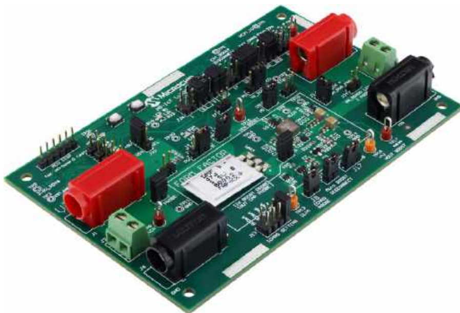
Fotografia 1. Zoptymalizowany projekt referencyjny układu zarządzania zasilaniem do urządzeń NB-IoT
