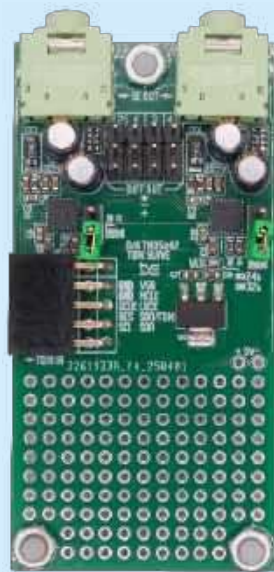
Fotografia 3. Zmontowany moduł DSP1701A_DACTDM_TAA5142
