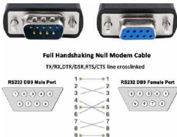
Rysunek 22. Kabel ze skrzyżowanymi sygnałami, tzw. handshaking null modem ( https://t.ly/ksQia )
