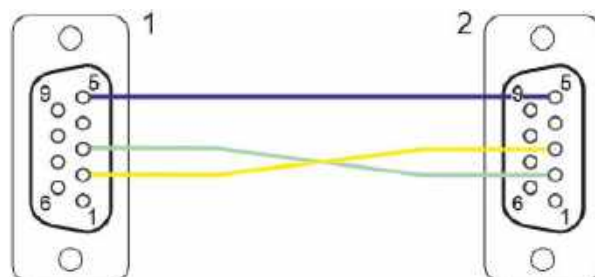
Rysunek 21. Podstawowy wariant kabla RS-232 do połączenia dwóch urządzeń DTE ( https://t.ly/IgWw )
