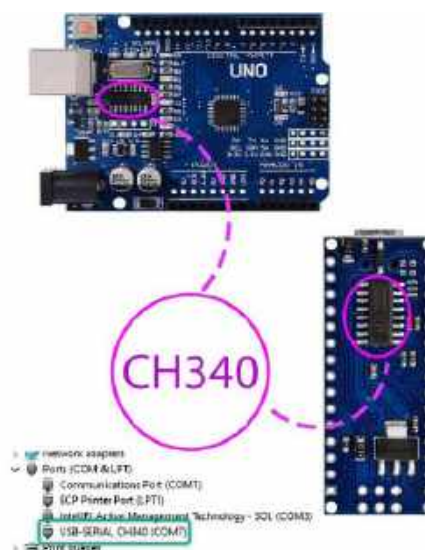
Rysunek 17. Konwerter UART-USB zbudowany na bazie układu CH340G, zastosowany w niektórych płytkach kompatybilnych z Arduino ( https://t.ly/56Yer )
