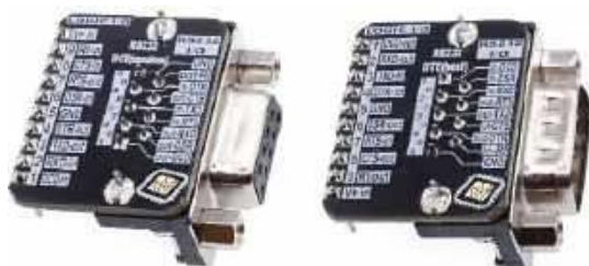
Fotografia 4. Gotowe moduły z odpowiednimi złączami w konfiguracji DTE i DCE, zbudowane na bazie układów Maxim (Analog Devices) MAX3243 oraz MAX3238 ( https://t.ly/yGelx )
