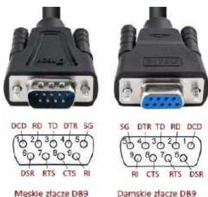
Rysunek 20. Złącza DB-9 stosowane z interfejsami RS-232 ( https://t.ly/Ocklg )
