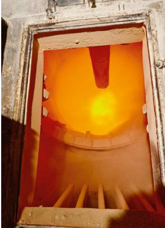
Obrotowy piec wapienny – komora spalania w fabryce węgla wapnia
