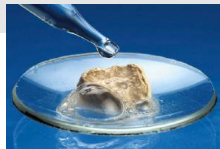
Reakcja kredy z kwasem solnym. W czasie tego procesu wydziela się dwutlenek węgla.
