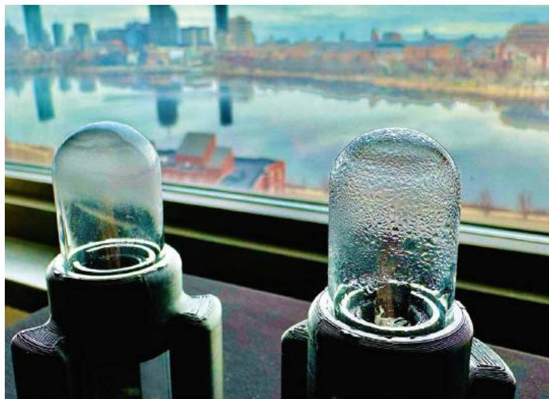
„Wytrząsanie” wody z powietrza przy pomocy ultradźwięków
