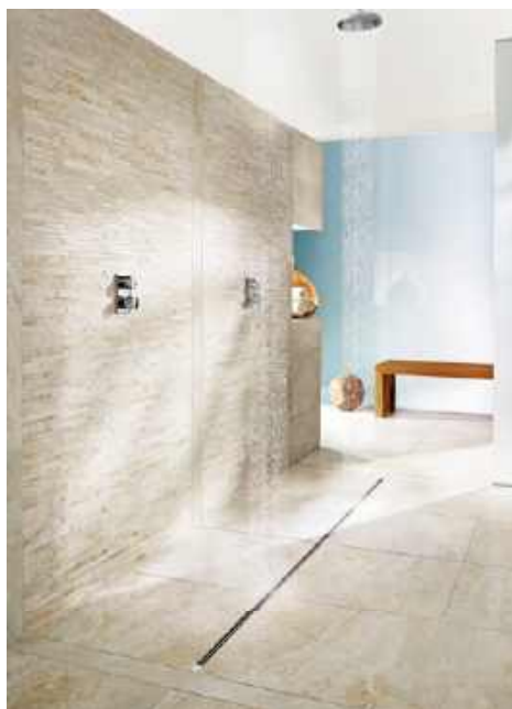
🔦 Odpływ liniowy zbiera wodę bezpośrednio z posadzki. VIEGA
