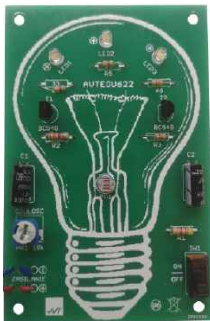
Fotografia 11. Zmontowany układ, widok od strony komponentów
