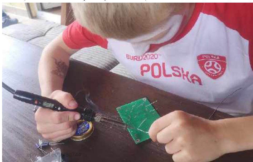
Fotografia 4. Prawidłowy sposób trzymania kolby lutowniczej przez osobę praworęczną. Na zdjęciu Sebastian, koło zainteresowań Młodych Entuzjastów Elektroniki, Wrocław
