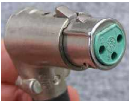
Rysunek 6. Złącze XLR Switchcraft dla tych, którzy lubią solidną amerykańską estetykę lat 70. Jest to wersja kątowna, która nie wystaje tak bardzo jak prosta
