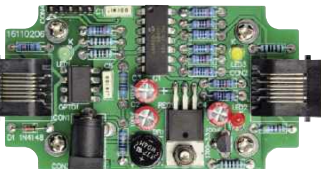
Rysunek 2. Montaż płytki drukowanej jest stosunkowo prosty. Należy zamontować elementy, jak pokazano tutaj, zwracając szczególną uwagę na kierunek IC1, OPTO1, kondensatorów elektrolitycznych, diody D1 i diod LED. Jeśli wystąpią problemy związane z sygnałami sterującymi wpływającymi na taktowanie, pomocny może być kondensator o małej pojemności (10 pF) między nóżkami 6 i 14 układu IC1
