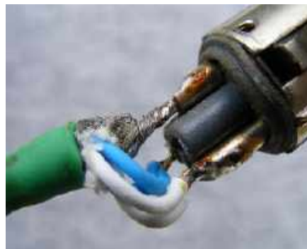
Rysunek 17. Prawidłowe zakończenie kabla Star Quad na XLR. Żyły tego samego koloru są połączone równolegle. Uwaga: niebieski jest przewodem „zimnym”
