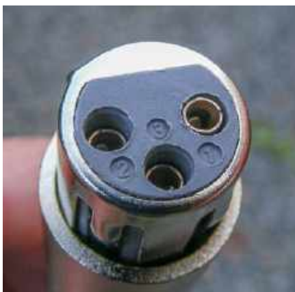
Rysunek 4. Uziemienie złącza XLR (prawy górny róg) zawsze podłącza się jako pierwsze, ponieważ jest nieco dłuższe niż pozostałe – co za wsparciały pomysł!
