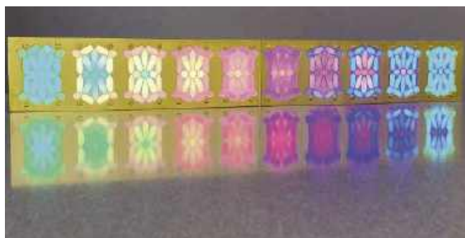
Rysunek 12. Układ dziesięciu 21-segmentowych wyświetlaczy Steve'a Manleya
