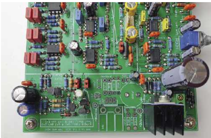
Ujęcie porównawcze pokazujące, które części zostały pominięte w wersji z pojedynczą linią zasilania (pokazanej powyżej) i w wersji z podwójną linią poniżej
