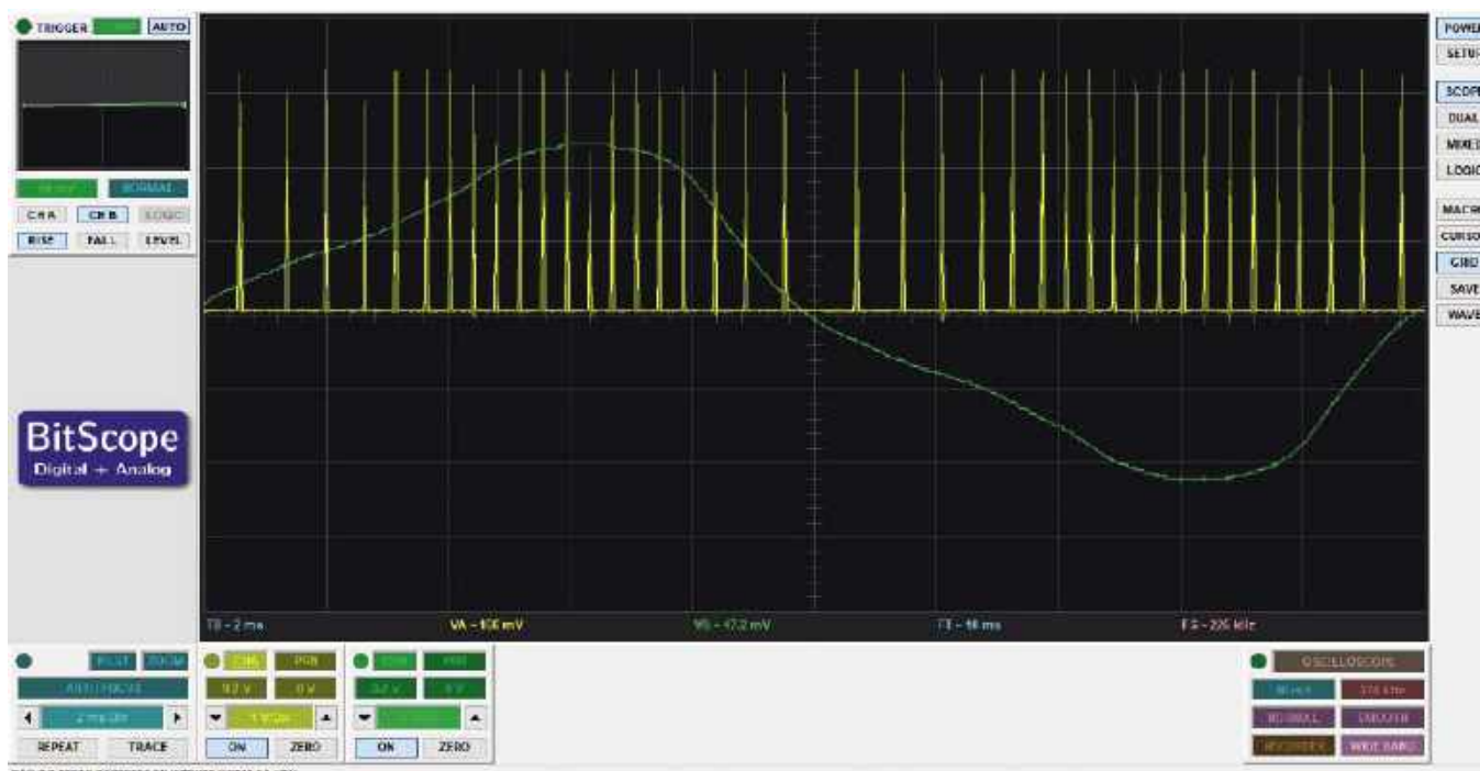
Oscylogram 1. Timing impulsów rejestru latch w odniesieniu do przebiegu sieciowego. Przebieg prądu przemiennego jest dość znacznie zniekształcony ze względu na właściwości transformatora i krótki prąd rozruchowy w kondensatorze poprzedzający szczyty przebiegu. Mimo to, jest wystarczająco dobry, aby wykrywać przejście przez zero. Bardziej rozłożone w czasie impulsy w pobliżu szczytów napięcia sieciowego zapewniają bardziej równomierne stopnie jasności dla lamp żarowych bez zbyteńnego wpływu na zasilanie sieciowe diody LED
