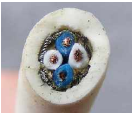
Rysunek 16. Kabel Star Quad ma cztery rdzenie i lepiej redukuje wpływ zewnętrznego pola magnetycznego
