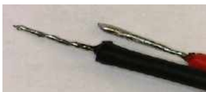
Fotografia 9. Obszar odstosowanej izolacji, po cynowaniu kabelków
