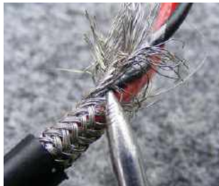
Rysunek 13. Pleciony kabel ekranowany jest najlepszy, ale wymaga pracochłonnego rozczesania, aby umożliwić jego prawidłowe skręcenie i lutowanie
