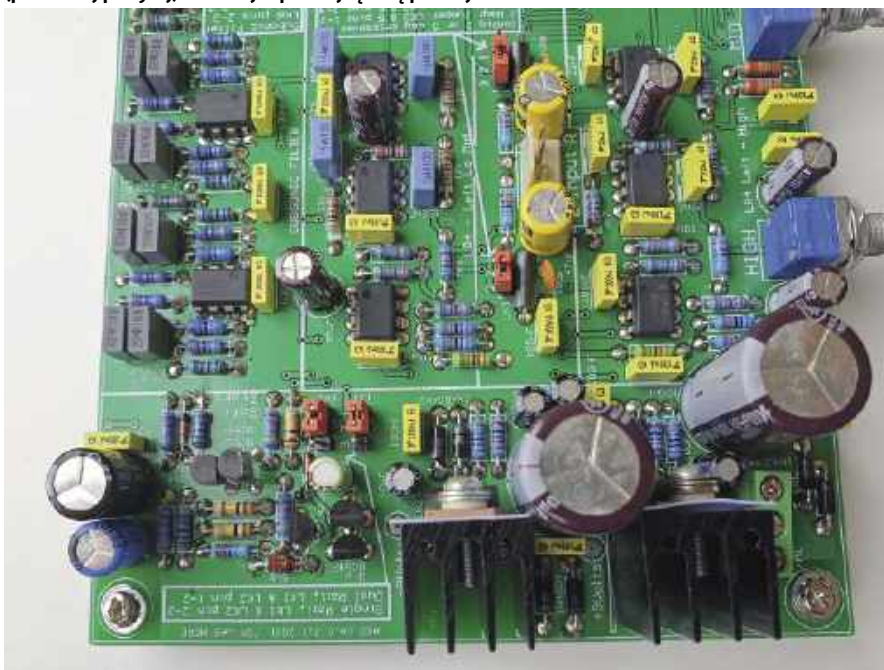
Ujęcie porównawcze pokazujące, które części zostały pominięte w wersji z pojedynczą linią zasilania (pokazanej powyżej) i w wersji z podwójną linią poniżej
