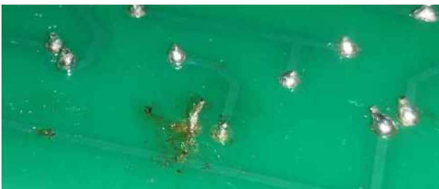
Fotografia 13. W środkowej części zdjęcia znajduje się element przewleczone przez otwory, wokół których brak jest pierścienia miedzi (zerwane pady)
