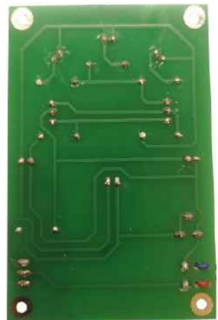
Fotografia 12. Zmontowany układ, widok od strony lutowania
