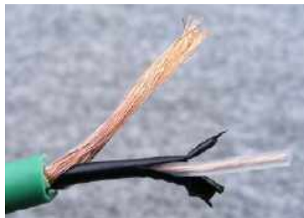
Rysunek 12. Niektóre ekranowane kable mają półprzewodzącą plastikową powłokę (zawsze czarną), która redukuje szumy. Ten kabel ma tylko jedną żyłę do zastosowań niesymetrycznych
