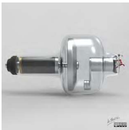
Lampa rentgenowska z wirującą anodą. Elektrony wylatują ze znajdującej się z prawej strony rozgrzanej katody. [4]
