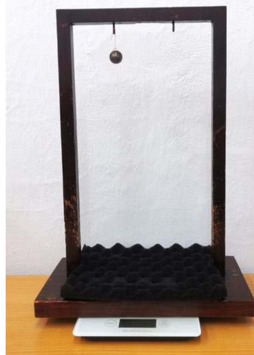
Fot. 2. Przykład układu doświadczenia do wykazania stanu nieważkości spadającej kulki.
