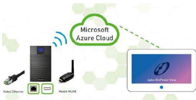
Rysunek 1. Zasilacze UPS z serii ICT/ICR IoT wysyłają wszystkie istotne dane do odpowiednio zabezpieczonej chmury Microsoft Azure Cloud
