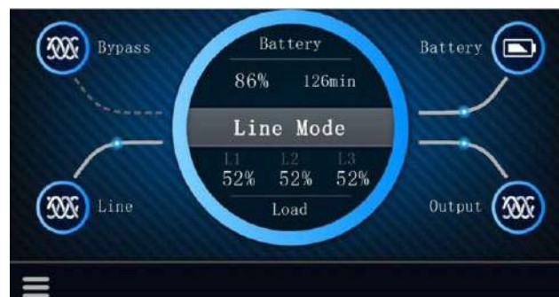
Rysunek 2. Dotykowy wyświetlacz dostępny w modelach trójfazowych
