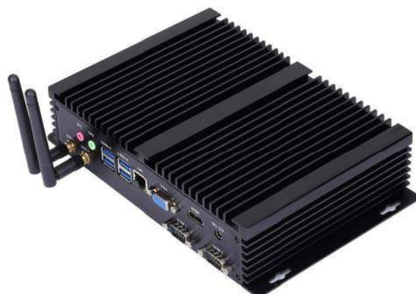
Fotografia 26. Przykładowy komputer przemysłowy zamontowany w obudowie ze zintegrowanym radiatorem: IM03-1165G7-00 ( https://t.ly/5Vgd )
