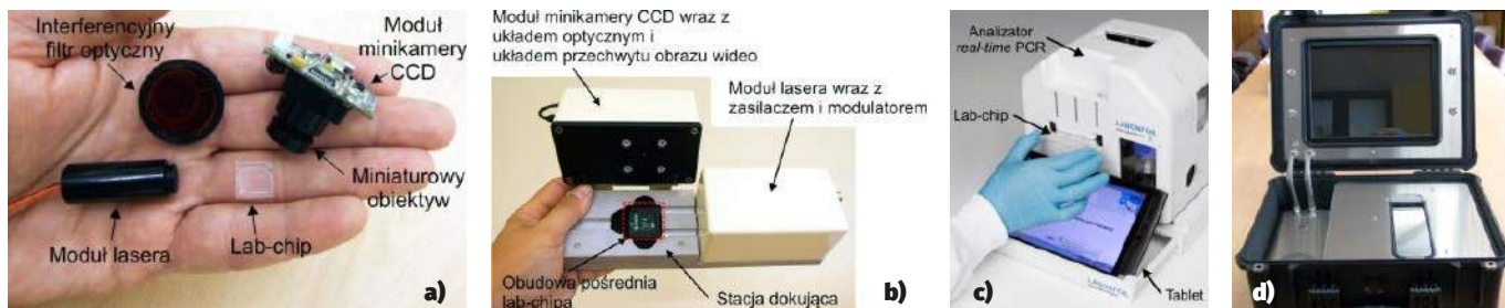
Rysunek 1. Miniaturowy system wzbudzenia i detekcji fluorescencji: a) wygląd kluczowych komponentów inteligentnego rozwiązania, b) przykłady miniaturowych instrumentów analitycznych do wykrywania materiału genetycznego patogenów – minireaktor PCR z odczytem optycznym do wykrywania patogenów żywności, c) instrument diagnostyczny do wykrywania zakażeń wirusowych, nowotworu raka jelita oraz złotych alg, d) przenośny (walizkowy) minireaktor PCR do wykrawania broni biologicznej w warunkach polowych
