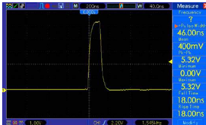
Rysunek 2. Oscylogram impulsu napięcia wyjściowego
