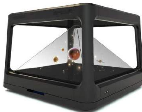
Fotografia 1. Urządzenie do projekcji holograficznej
