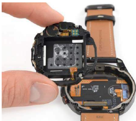
Fotografia 1. Wnętrze zegarka Samsung Galaxy Watch 3. Widoczna wkładka montażowa, wyprofilowana w sposób ściśle odpowiadający zamontowanym na niej komponentom elektronicznym ( https://bit.ly/3MBWkAS )
