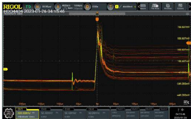
Rysunek 13. Tryb persistence w połączeniu z barwnym obrazowaniem statystyki sygnału daje ogromne możliwości podczas debugowania sygnałów analogowych, jak i cyfrowych
