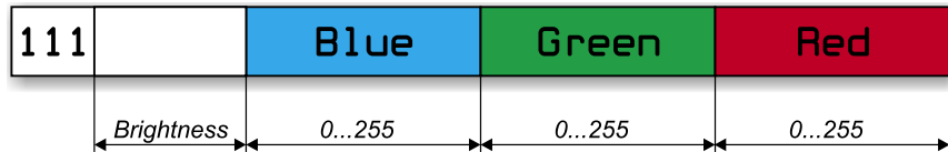
Rysunek 4. Konstrukcja ramki transmisji danych użytecznych diody APA102
