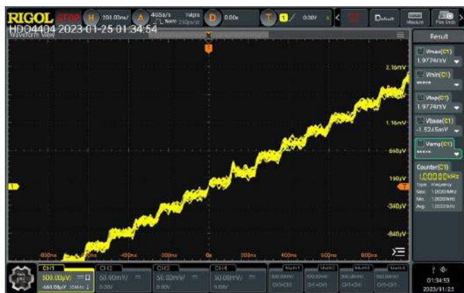
Rysunek 11. Doskonałe parametry torów analogowych oscyloskopu umożliwiają nawet bezpośrednią wizualizację poziomów kwantowania sygnału z generatora arbitralnego (akwizycja w trybie normalnym z próbkowaniem 4 GSps, podstawa czasu równa 200 ns/div)
