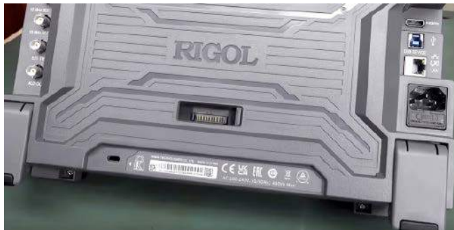
Fotografia 5. Wygląd złącza opcjonalnego akumulatora po odstąpieniu zaśleпки ( https://t.ly/7mv3 )
