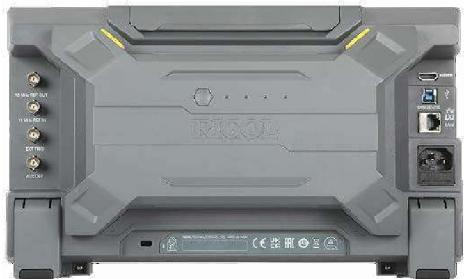
Fotografia 4. Wygląd tylnej części oscyloskopu. Fotografia pokazuje urządzenie z podłączonym akumulatorem, zajmującym większą część tylnej pokrywy obudowy ( https://t.ly/Du5t )
