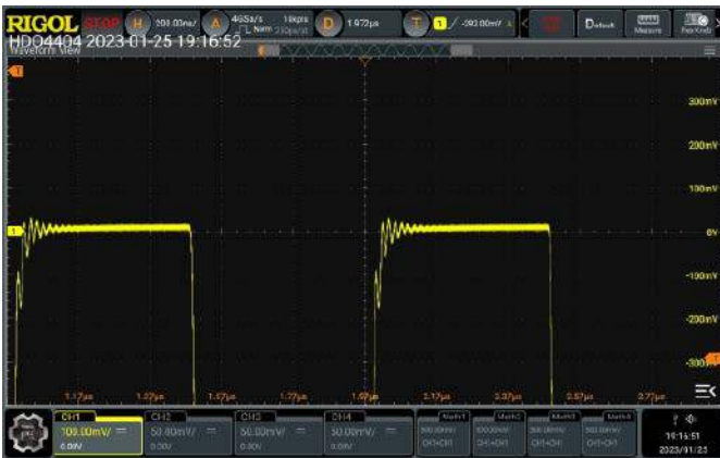
Rysunek 8. Przebieg z rysunku 7 przesunięty za pomocą biasu, ustawionego na wartość równą -500 mV, a następnie powiększony do 100 mV/div
