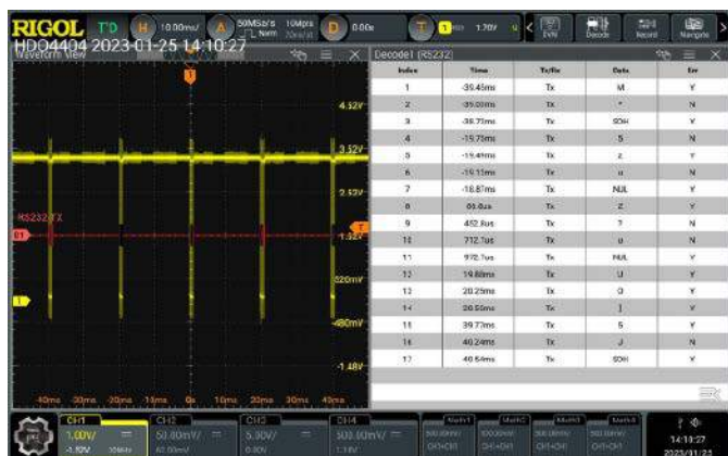
Rysunek 5. Wielokrotne próby zdekodowania sygnału UART spęły na niczym
