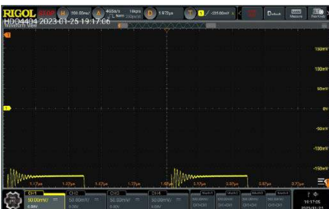
Rysunek 9. Obraz sygnału z rysunku 8 po zwiększeniu wzmacnienia do 50 mV/div (reszta ustawień bez zmian)
