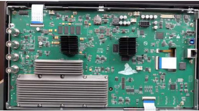
Fotografia 11. Masywny radiator, pokrywający całość front-endów oscyloskopu, pełni także funkcję efektywnego ekranu, co ma spore znaczenie w przypadku niskoszumnej, 12-bitowej konstrukcji urządzenia (https://t.ly/6Cs6)
