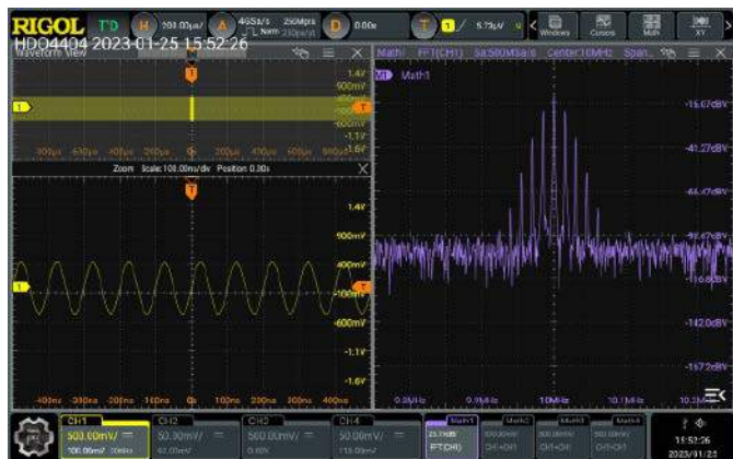
Rysunek 4. Akwizycja sygnału o modulacji FM oraz jego widmo, wyznaczone przez wbudowaną funkcję FFT. Warto zwrócić uwagę na bardzo dobrą jakość odwzorowania piku nośnej oraz wstęg bocznych, a także duży odstęp sygnału od szumu
