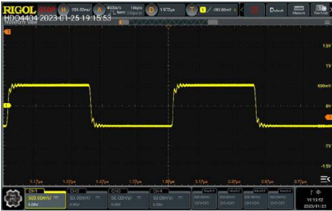
Rysunek 7. Przebieg, który posłużył do testowania możliwości offsetu pionowego i regulacji biasu toru analogowego
