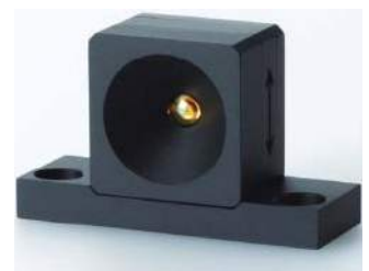
Fotografia 10. Kaskadowy detektor kwantowy P16309-01, mogący pracować z podczerwienią w zakresie MIR (pik czułości równy 4,65 \mu\text{m} ) i oferujący pasmo dochodzące do 20 \text{ GHz} ( https://t.ly/Z4dl )
