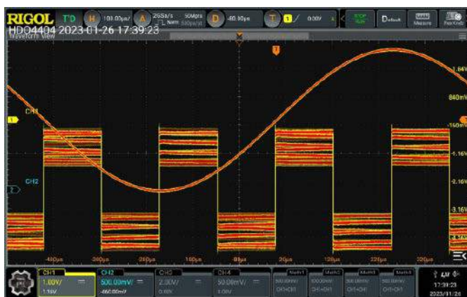
Rysunek 14. Dwa sygnały wyświetlane w trybie reprezentacji barwnej. Po lewej stronie ekranu widoczne dodatkowe znaczniki numerów kanałów
