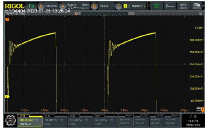
Rysunek 10. Zniekształcenie sygnału prostokątnego o amplitudzie 2 Vpp przy wzmacnieniu na poziomie 200 mV/div
