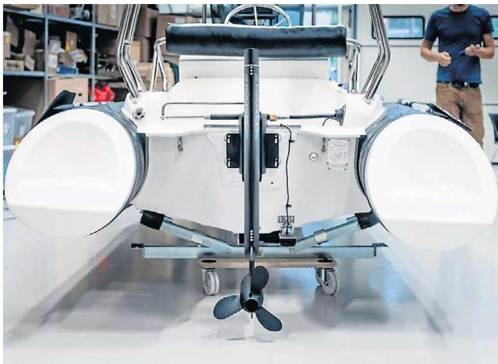
Ultrakompaktowy napęd Z10 ma ułatwić przejście floty na prąd: mniej części, niższe koszty użytkowania i potencjał do szerokiego zastosowania
