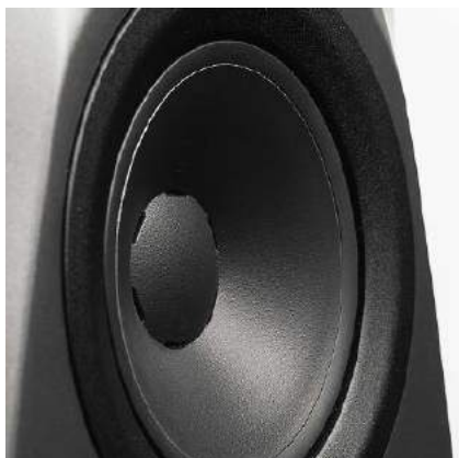
Przetwornik średniotonowy ma wąskie, wklęsłe górne zawieszenie, dzięki czemu krawędź membrany znajduje się blisko wyprofilowania.
