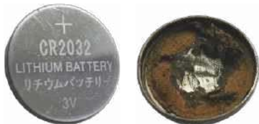
5. Twoje źródło litu – z lewej ogniwo litowe, z prawej widoczny metaliczny lit naniesiony na obudowę
