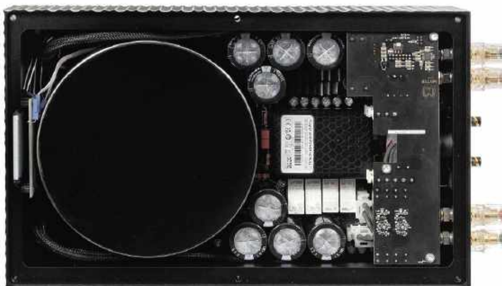
Liniowy zasilacz z dużym transformatorem obsługuje małą puszkę wzmacniacza impulsowego.
