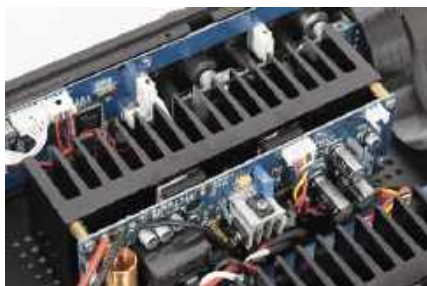
Końcówki mocy rozdzielono między dwa moduły, każdy z własnym radiatorem.
