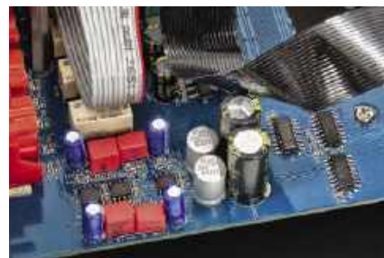
Układ przedwzmacniacza gramofonowego jest typowy, z niskoszumowymi wzmacniaczami operacyjnymi i wysokiej klasy elementami pasywnymi.
