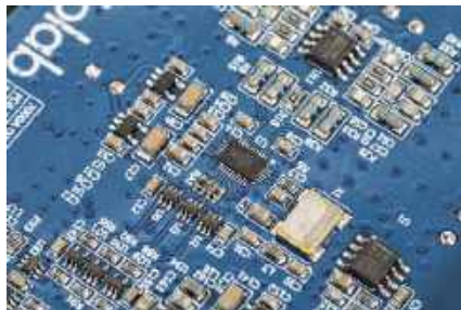
Moduł cyfrowy znajduje się w tylnej części, Audiolab wykorzystał jeden z najlepszych przetworników C/A ESS Technology – ES9038Q2M.
