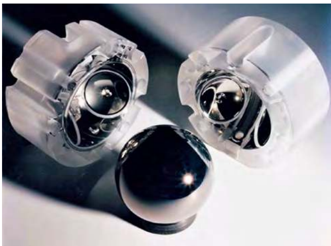
Rotor Gyro-4 z satelity Gravity Probe B. Źródło: www.einstein.stanford.edu
