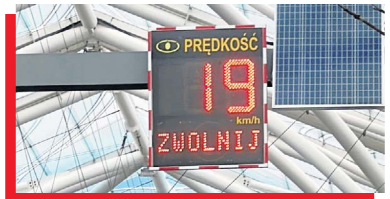
Wyświetlacz pokazuje prędkość wjeżdżającego na przystanek tramwaju. Nie powinna być większa niż 10 km/godz.
