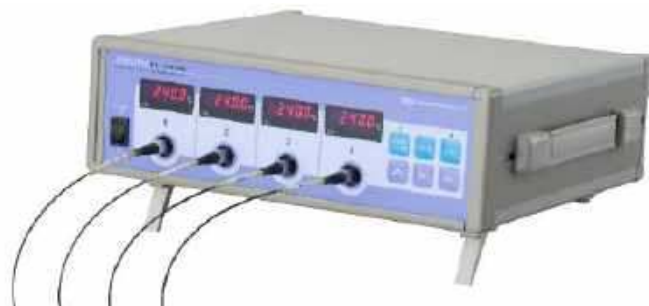
Fotografia 17. Przykładowe zastosowanie aluminiowej obudowy przyrządowej Takachi z serii MOY ( https://t.ly/JKMdH )
