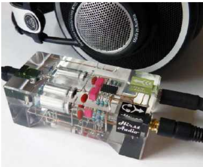
Fotografia 5. Crystal CMoy, wzmacniacz słuchawkowy zatopiony w akrylu. Po zdjęciu formy odlewniczej taki układ może wymagać dodatkowej obróbki mechanicznej: szlifowania i polerowania
