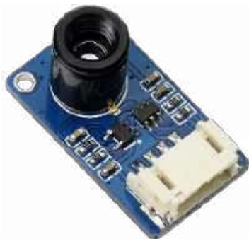
Fotografia 1. Kamera termowizyjna IR MLX90641 firmy Waveshare [3]
