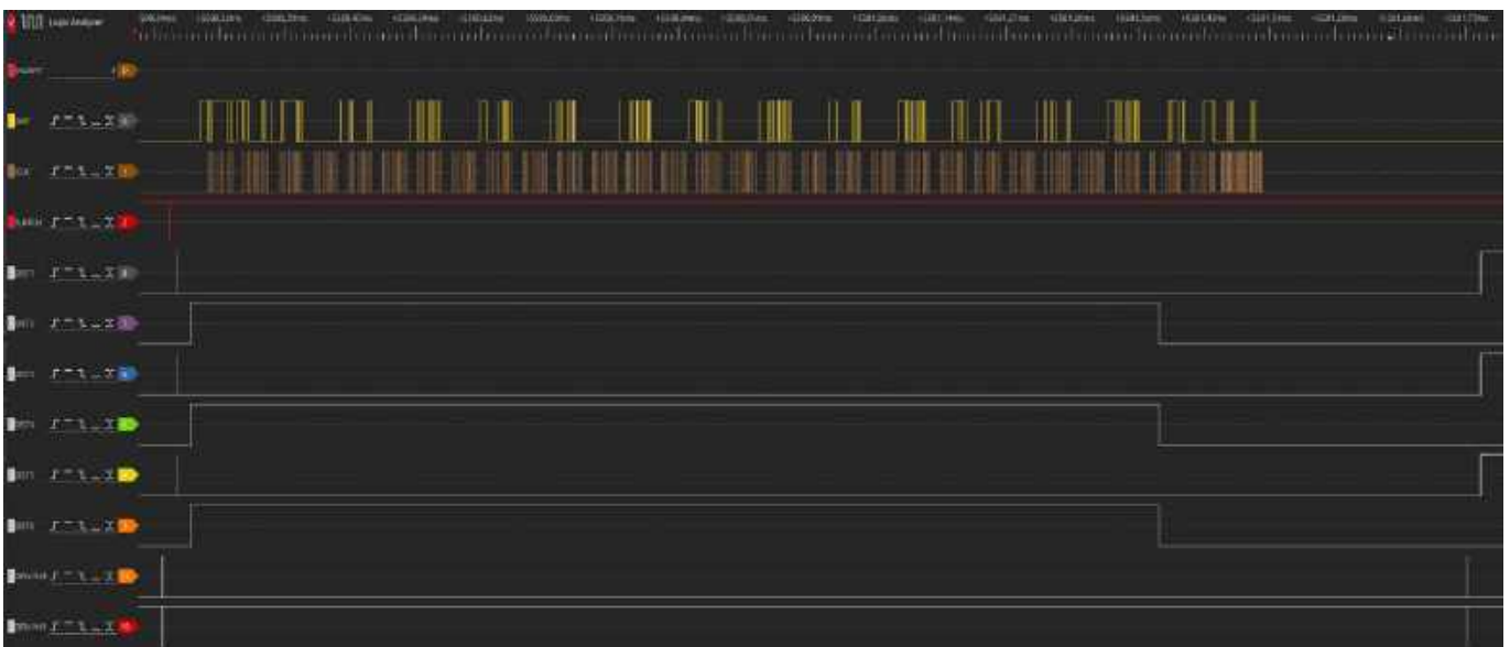
Rysunek 6. Przybliżenie fragmentu komunikacji z mechanizmem termicznym, odpowiedzialnego za przestanie danych pojedynczej linii pikseli (źródło: archiwum własne autora)
