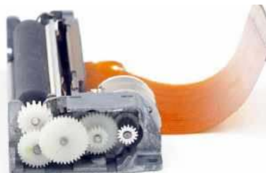
Fotografia 8. Widok przekładni wałka napędowego po usunięciu tworzywowej pokrywy
