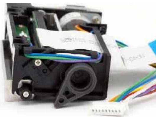
Fotografia 9. Dźwignia zwalnająca zatrask mocujący wałek. Po lewej stronie widoczny jest elektromechaniczny czujnik obecności wałka
