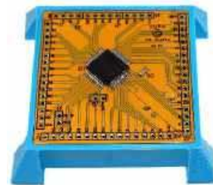
Fotografia 13. Płytkę na dedykowanej podstawie, wykonanej na drukarce 3D
