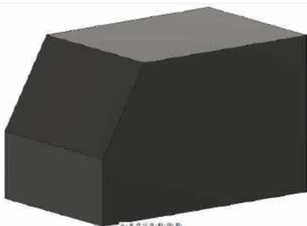
Rysunek 1. Bryła projektowanej obudowy zaprojektowana z użyciem porporcji złotego podziatu
