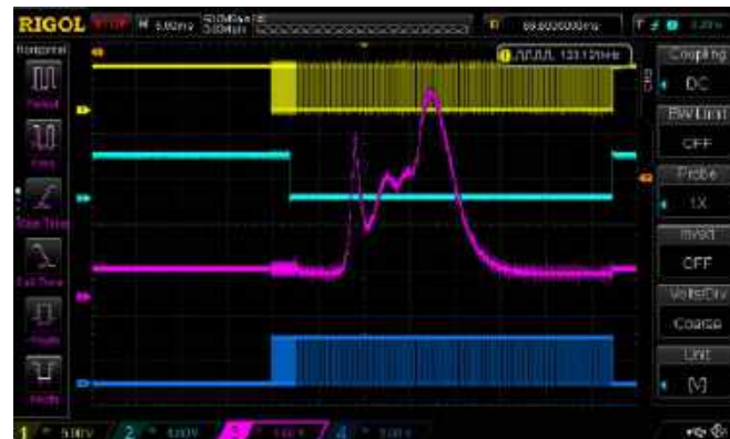
Rysunek 6. Oscylogram zarejestrowany podczas wykonywania pojedynczej akwizycji za pomocą minispektrometru marki Hamamatsu. CH1 – sygnał na linii CLK, CH2 – sygnał na linii START, CH3 – sygnał na linii VIDEO, CH4 – sygnał na linii TRIG
