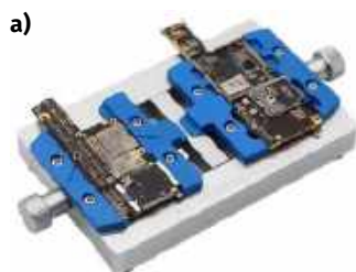
Fotografia 11. Uchwyty na płytce drukowanej: mniejszy (a) i duży uchwyt firmy Weller (b). To profesjonalne narzędzie kosztuje ponad sześć tysięcy złotych
