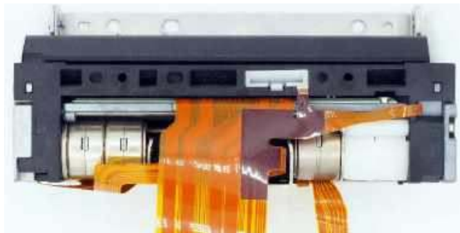
Fotografia 12. Moduł drukarki termicznej z wbudowanym obcinaczem automatycznym. Główna taśma FPC udostępnia zasilanie i sygnały logiczne głowicy, przewody silnika napędowego i połączenia z czujnikami, zaś druga, węższa taśma obsługuje silnik i czujnik obcinacza papieru
