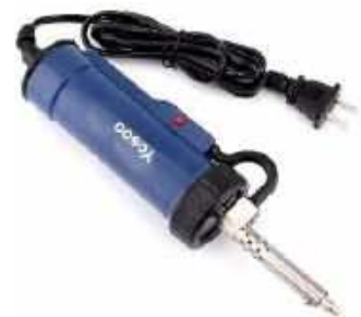
Fotografia 7. Chińska rozlutownica ze zintegrowaną w kolbie pompką. Ten model nie ma regulacji temperatury
