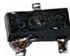
Fotografia 1. Przeciążony tranzystor BC807
