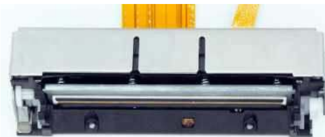
Fotografia 10. Moduł średnioformatowej drukarki termicznej z doskonale widocznym, optycznym czujnikiem papieru w postaci transoptora odbiciowego, wlutowanego bezpośrednio na sztywno-giętkiej płycie drukowanej
