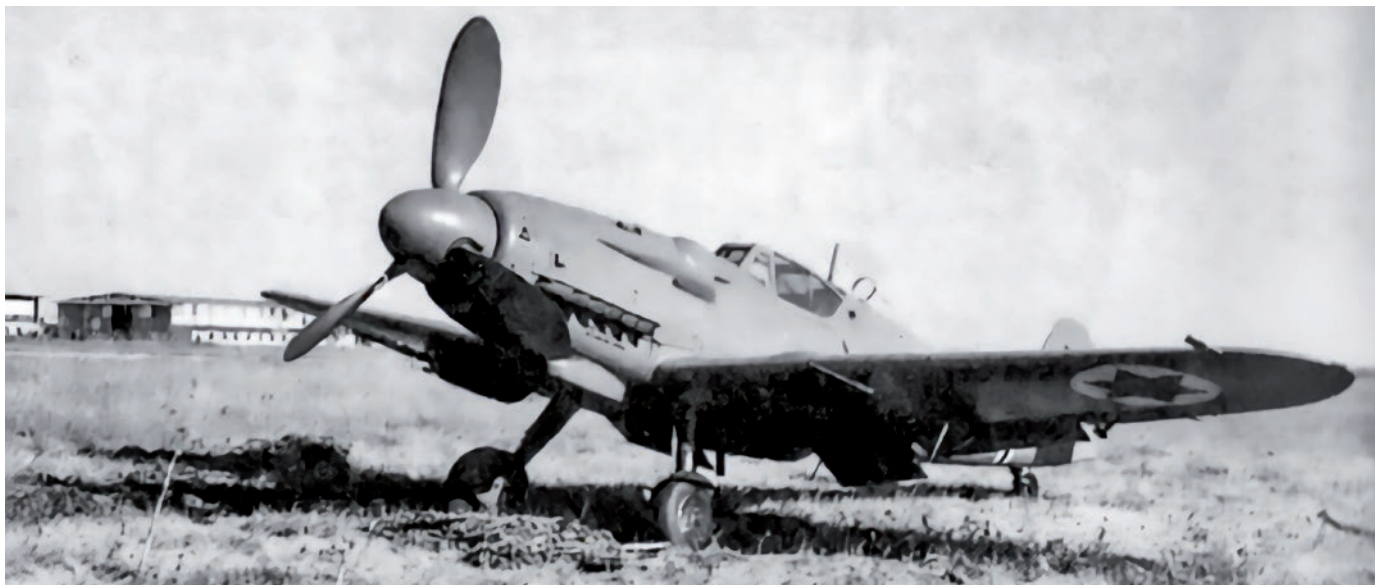
▲ Samoloty Avia S-199 produkowane po wojnie w latach 1947-1949 w zakładach Avia w Pradze i Aero Letnany. Konstrukcja przedstawiała sobą niezbyt udany melanz kadłuba (produkowanego w Protektoracie Czech i Moraw) Messerschmitta Bf 109G, silnika Jumo 211 F dla samolotów bombowych He 111 oraz śmigła VS 11 (mniejszego cięższego niż montowane pierwotnie w samolotach Bf 109G).
