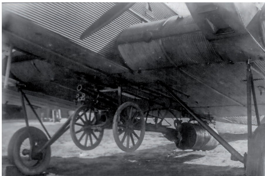
► Bombowiec TB-3 z podwieszoną na systemie PD-0 (G-37) 76 mm armatą górską wzór 1909 rok. Działo do transportu ma zdemonstrowaną pancerną tarczę ochronną. Za ogonem lawety widać cylindryczny pojemnik ze spadochronem.
