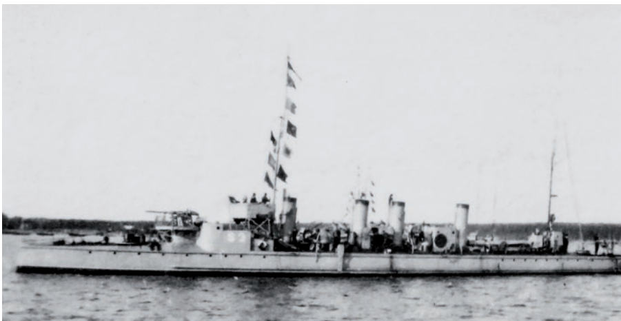
▲ Torpedowiec S2 został zbudowany w 1899 roku i wszedł do służby jako Gagara, a w 1902 roku pływał jako Prozorliwyj. W 1919 roku uzbrojony był w dwie armaty wz. 1906 kalibru 75 mm i jedną wyrzutnię torped kalibru 380 mm.
