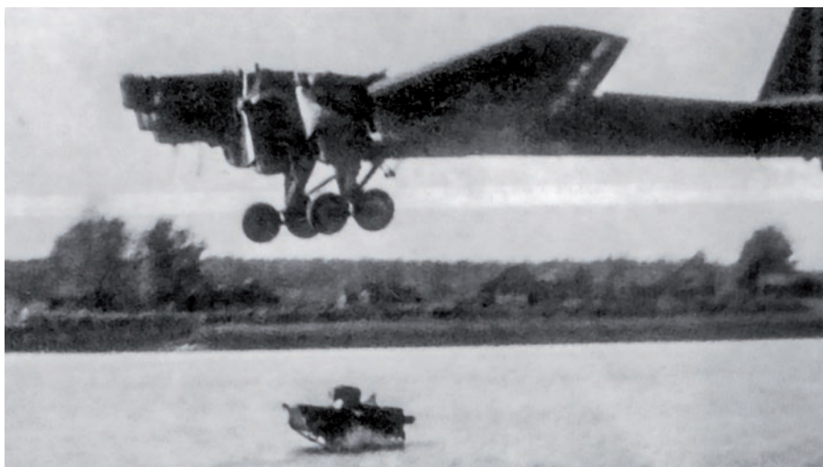
▲ Zrzut czołgu T-37A na powierzchnię zbiornika wodnego. Ze względów bezpieczeństwa minimalna wysokość zrzutu miała wynosić 5 m. Na zdjęciu widać, że była chyba dwukrotnie większa. Prowadziło to do poważnych uszkodzeń pojazdu. Do prób wykorzystywano samolot z silnikami M-34R. Za chwilę rozbrzyzg wody osiągnie kół bombowca.
