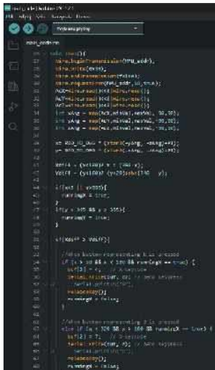
Rysunek 5. Ten fragment programu przetwarza dane z MPU6050 na ruchy myszki HID
