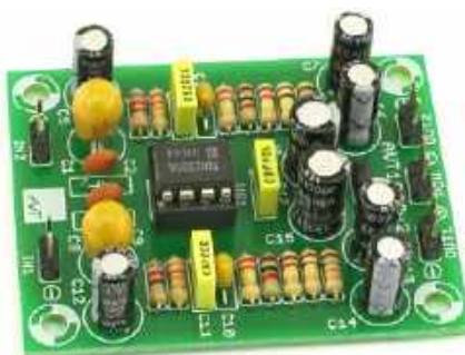
AVT1023 Przedwzmacniacz gramofonowy o charakterystyce RIAA https://sklep.avt.pl/avt1023.html
