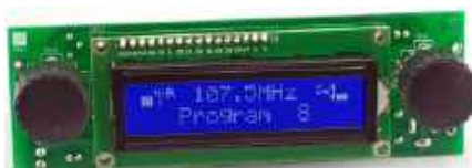
AVT5540 Radio FM z RDS https://sklep.avt.pl/avt5540.html
