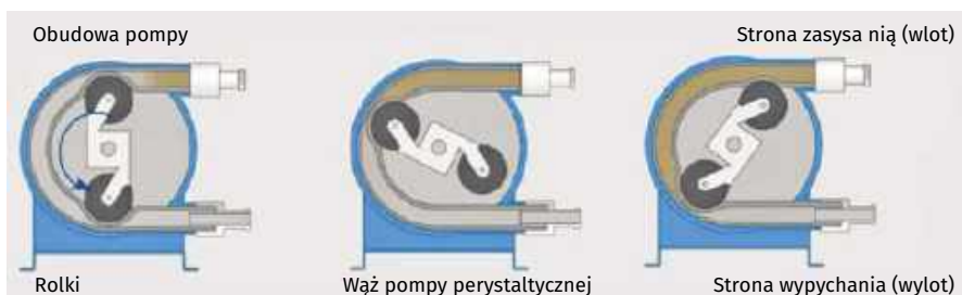
Rysunek 3. Rysunek obrazujący działanie pompy perystaltycznej
