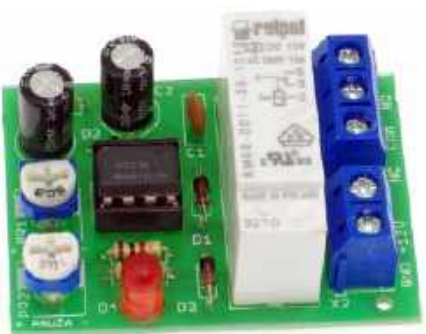
AVT1459 Uniwersalny układ czasowy https://sklep.avt.pl/avt1459.html
