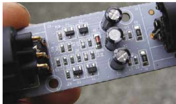
Rysunek 56. Niskoimpedancyjny blok wzmacnienia z zasilaniem fantomowym; musiał on zostać włożony pomiędzy mikrofon niskoimpedancyjny RE20 i przedwzmacniacz Teda Fletchera, aby uzyskać przyzwoity stosunek sygnału do szumu
