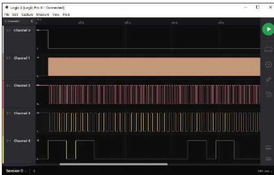
Rysunek 3. Zrzut ekranu z analizatora stanów logicznych, pokazujący, jak działa obwód generowania standardowego sygnału dzwonienia. Ch0 to linia „Cadence Start” (aktywny niski stan), Ch1 to przebieg prostokątny o częstotliwości 200 Hz na wyjściu O13 układu IC5, Ch2 to sygnał 20 Hz ze nóżki 12 układu IC6, Ch3 to sygnał sterujący 10 Hz podawany na nóżkę 14 układu dostępnym w punkcie TP5, a Ch4 to wynikowy sygnał wzorca sygnału dzwonienia, występujący na nóżce 10 układu IC10c (z odwróconą polaryzacją, a więc aktywny jest stan wysoki). Na rysunku przedstawiono standard AU
