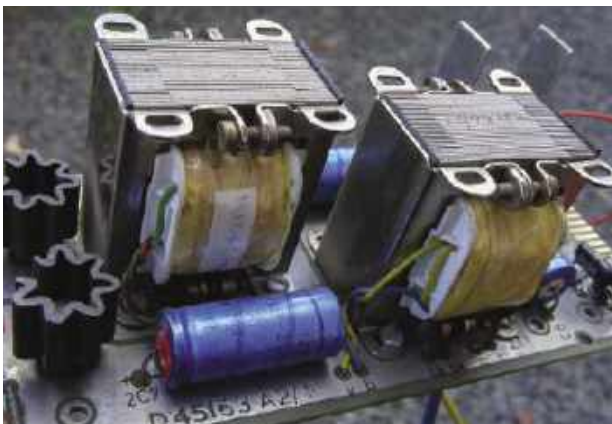
Rysunek 39. Waga zamiast sprzężenia zwrotnego – BBC używało konwencjonalnie sterowanych, dużych (43 mm wysokości) transformatorów z rdzeniem o dużej zawartości niklu, dla uzyskania niskich zniekształceń
