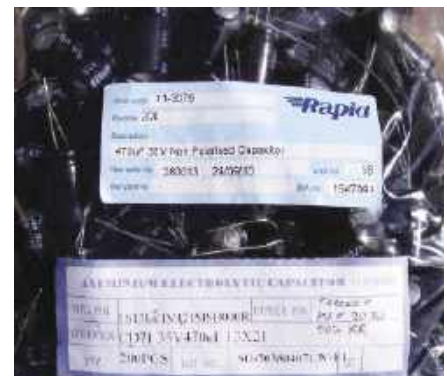
Rysunek 45. Bipolarne kondensatory elektrolityczne mają znikome zniekształcenia, ale mogą ulec degradacji, jeśli nie są używane. Wszystkie te kondensatory Suntan prawie eksplodowały podczas przechowywania
