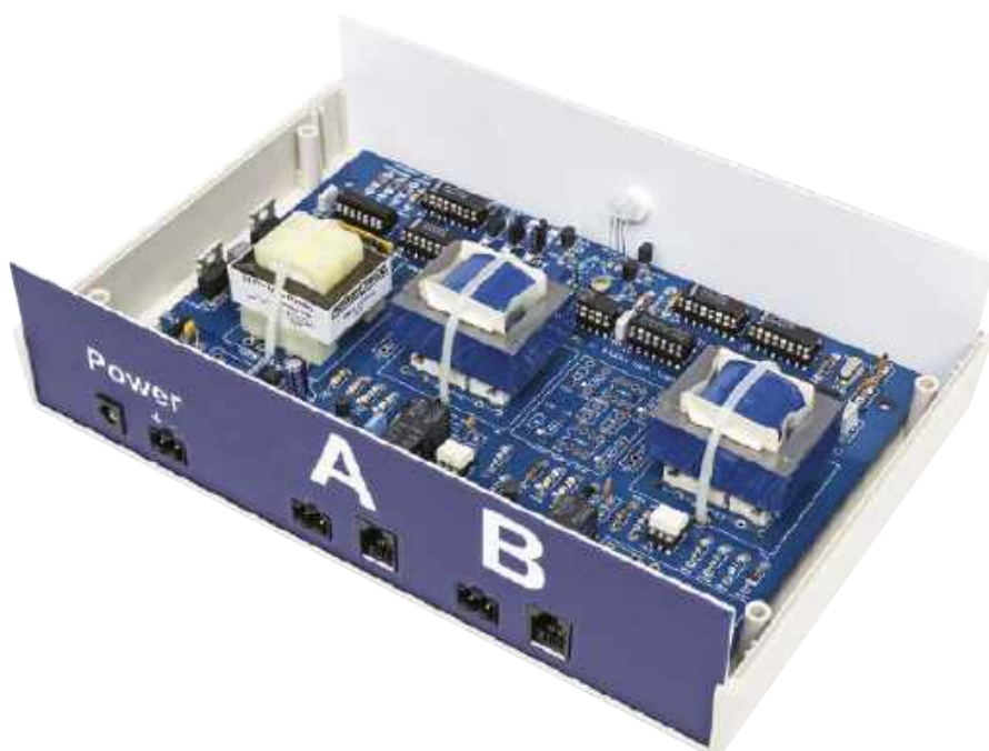
Zaleca się, aby urządzenie Tele-com było zamknięte w obudowie PacTec LH96-200, jak pokazano na rysunku (którą można kupić w RS Components lub Mouser). Jednak na płycie PCB znajdują się również otwory montażowe dla większej obudowy Altronics H0476
