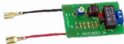
AVT1533 Zabezpieczenie akumulatora 12 V przed rozładowaniem https://sklep.avt.pl/avt1533.html
