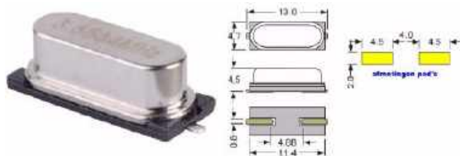
Rezonator HC-49 w wykonaniu SMD (© Conrad Electronic)
